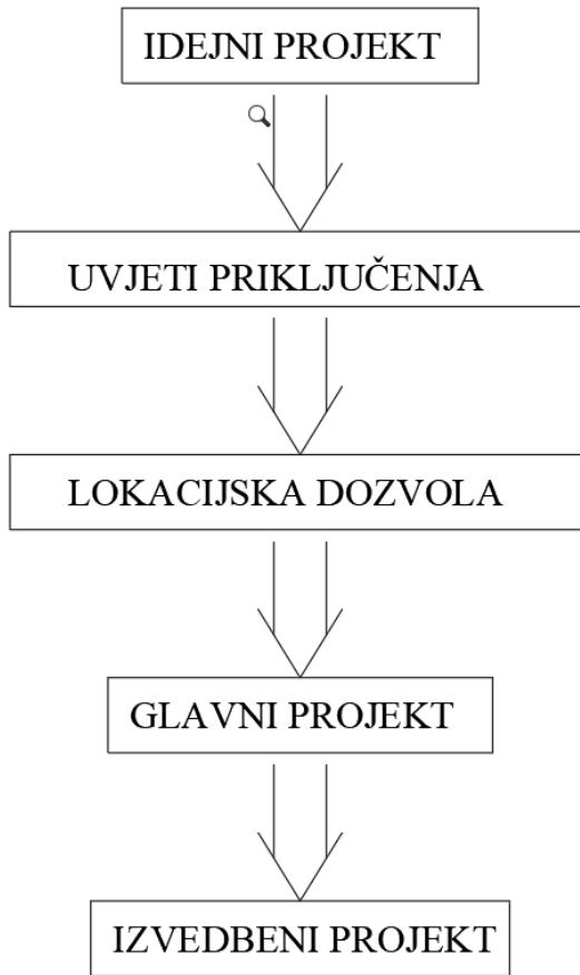
Slika 1.5 Prikaz radnji prije izrade izvedbenog projekta
