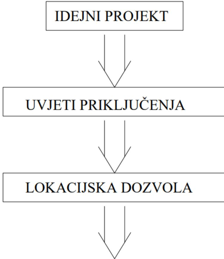
Slika 1.4 Prikaz pripremnih radnji prije izrade glavnog projekta
