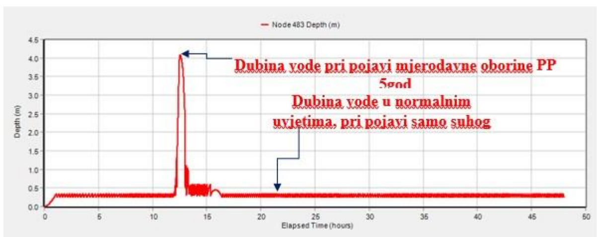
Slika 5.25 Dinamika rada crpki za oborinski dotok (3 x 500 l/s) pri pojavi mjerodavne oborine PP 5 god [5]
