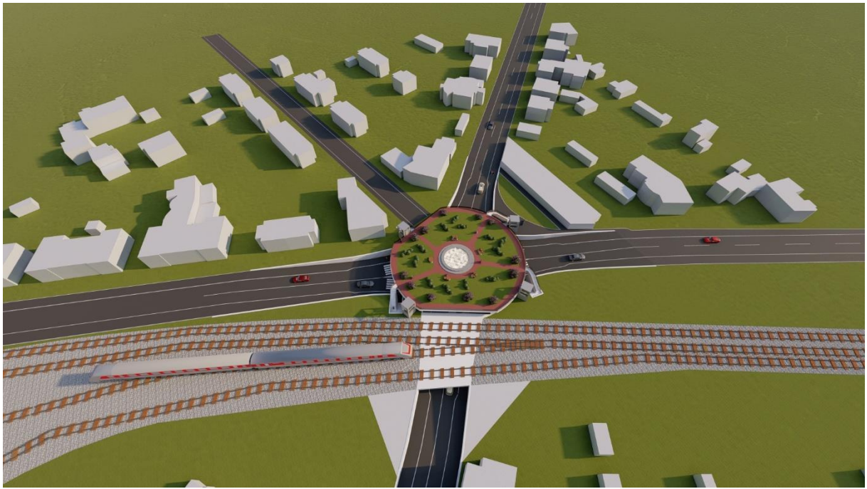
Slika 4.14 3D vizualizacija koncepta podvožnjaka i kružnog raskrižja
