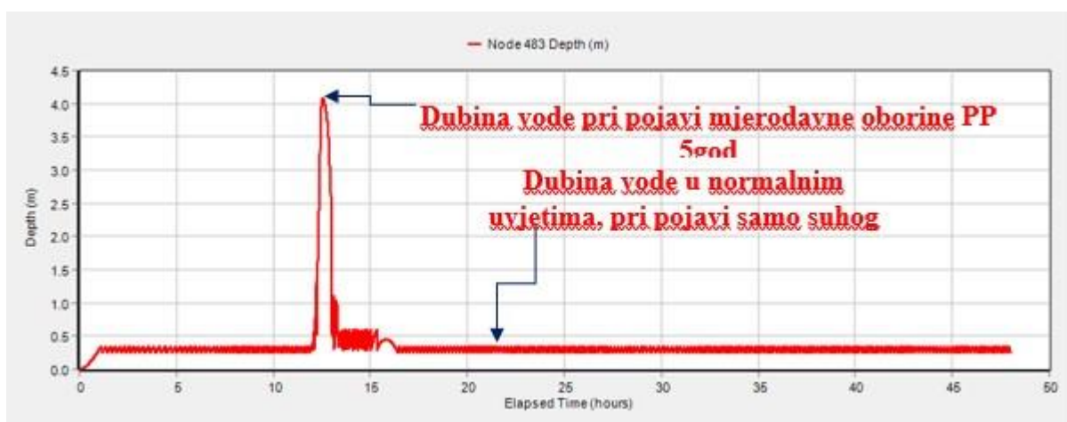
Slika 5.25 Dinamika rada crpki za oborinski dotok (3 x 500 l/s) pri pojavi mjerodavne oborine PP 5 god [5]
