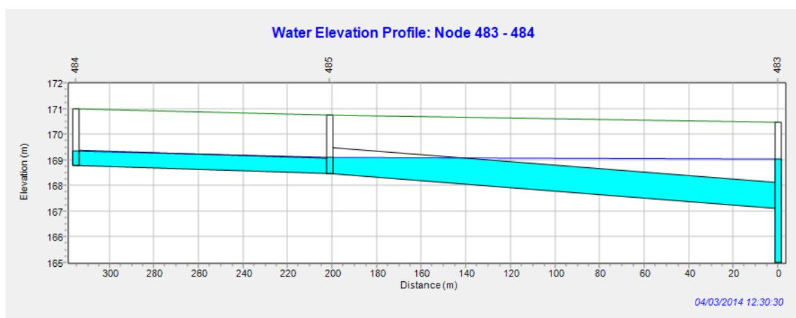
*Slika 5.22 Uzdužni profil kanala u Ul. F. Supila uzvodno od lokacije CS, iz smjera juga pri pojavu mjerodavne oborine PP 5 god [5]*
