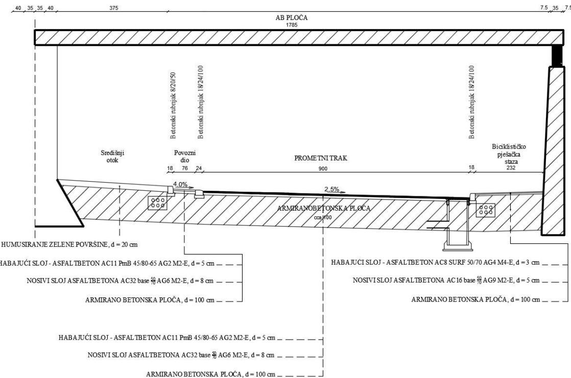
*Slika 5.2 Poprečni presjek građevinske situacije A-A [5]*
