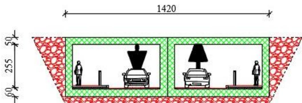
Slika 5.32 Poprečni presjek podvožnjaka
