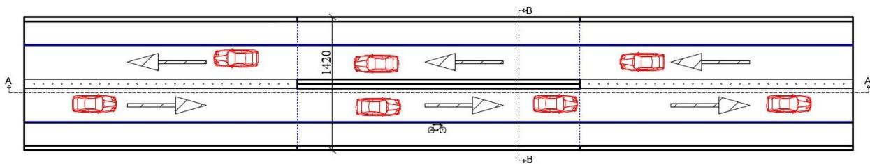
Slika 5.30 Tlocrt podvožnjaka
