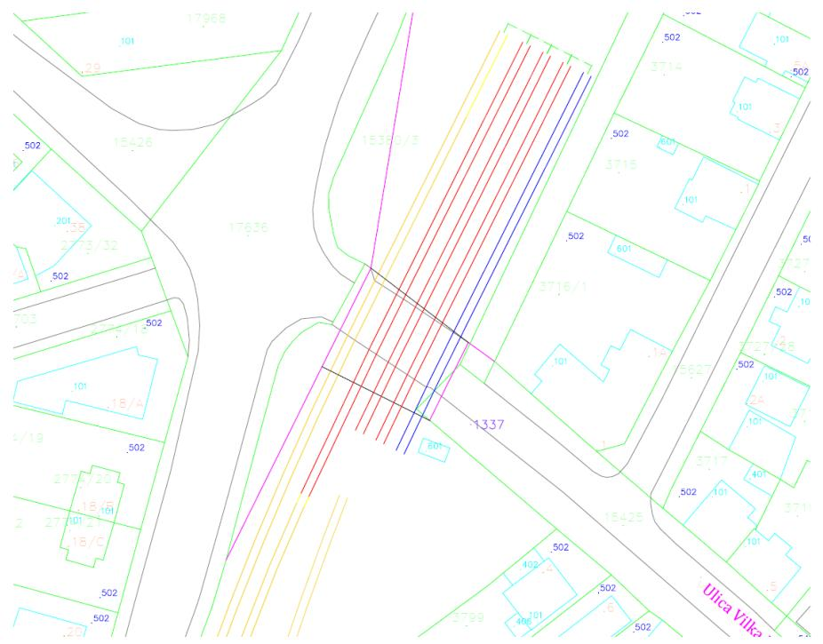
Slika 5.15 Pozicije kolosijeka na konstrukciji podvožnjaka [5]
