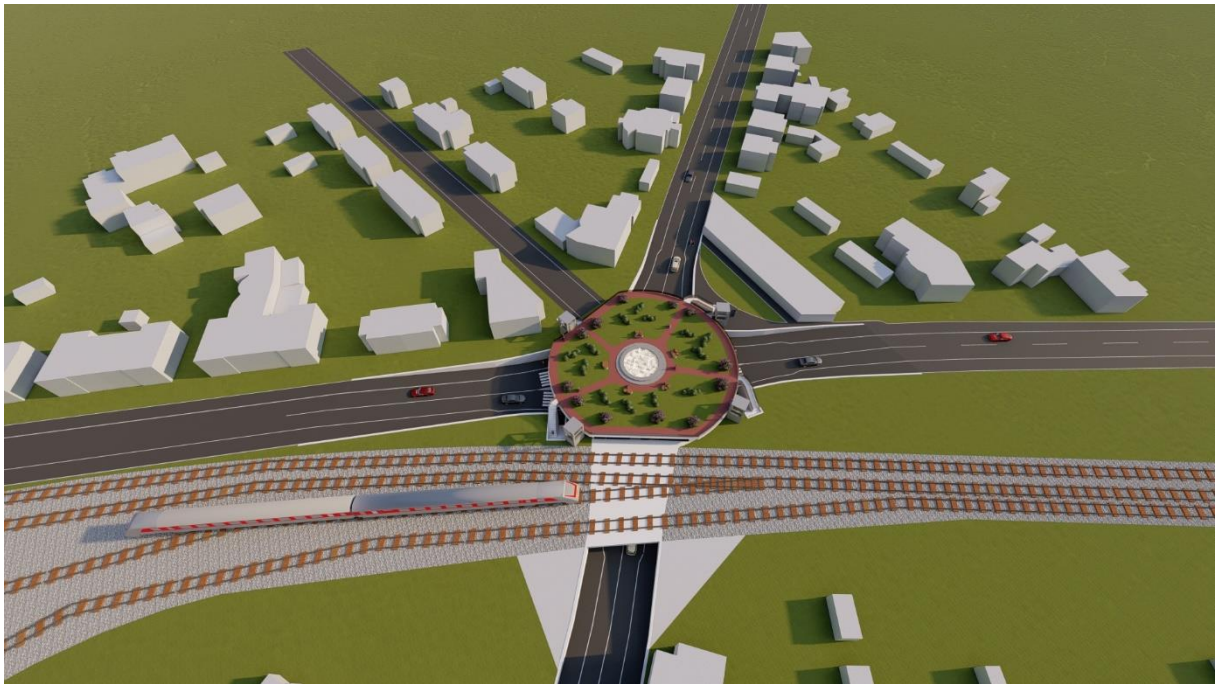
Slika 4.14 3D vizualizacija koncepta podvožnjaka i kružnog raskrižja
