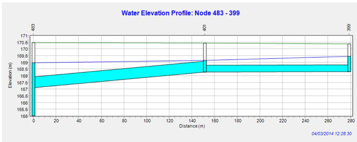
*Slika 5.21 Uzdužni profil kanala u Ul. F. Supila uzvodno od lokacije CS, iz smjera sjevera pri pojavu mjerodavne oborine PP 5 god [5]*
