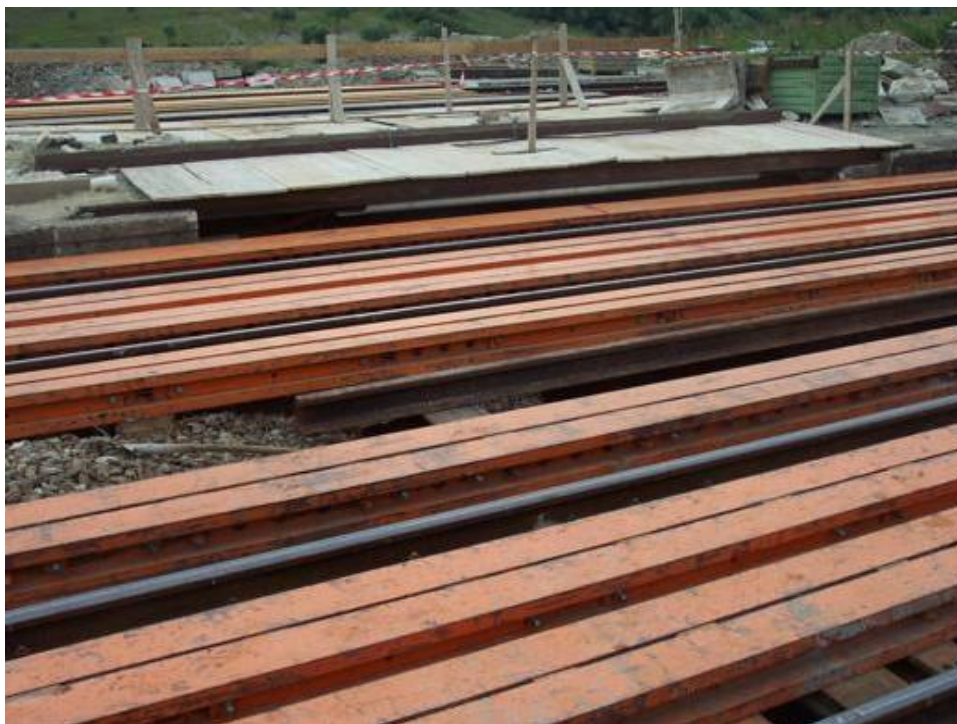
Slika 5.12 Čelične grede tipa HEB 300-400 [2]
