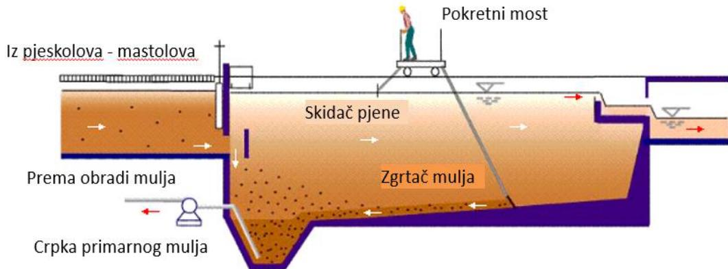
**Slika 4.7.** Shematski prikaz uzdužnog presjeka prethodnog taložnika [8]
