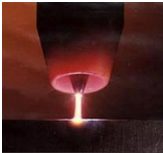
Slika 15. Prikaz sapnice za plazma zavarivanje [3]
