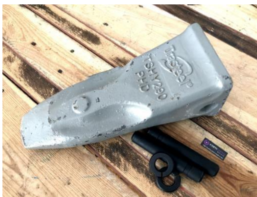
Slika 24. Zub žlice na bageru. [16]
