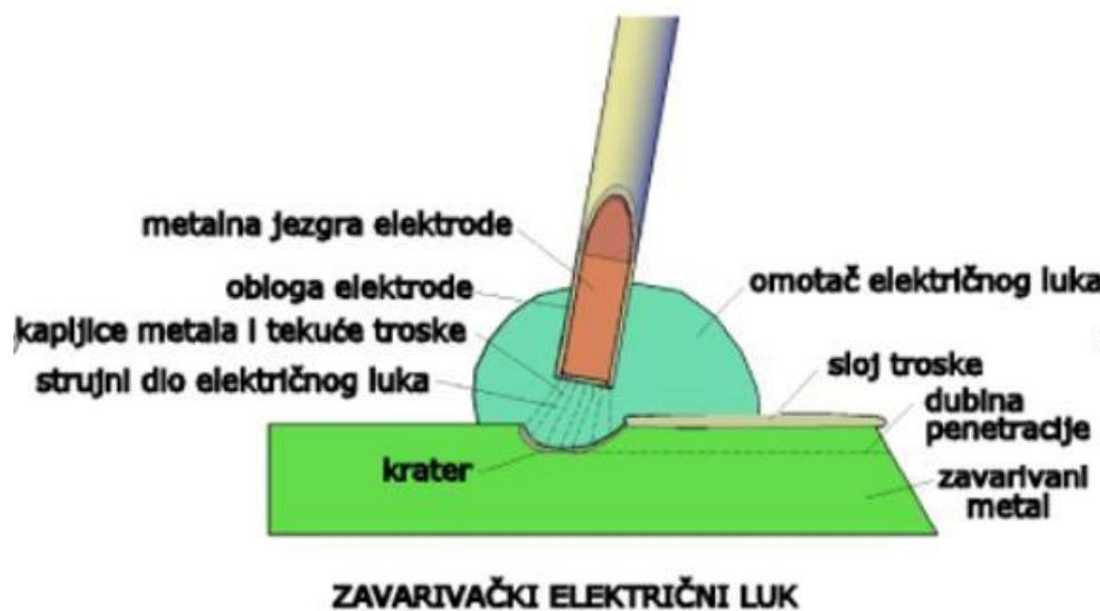
Slika 3. REL postupak zavarivanja [4]
