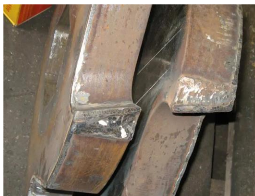
Slika 25. Navareni noževi za mljevenje otpada. [18]
