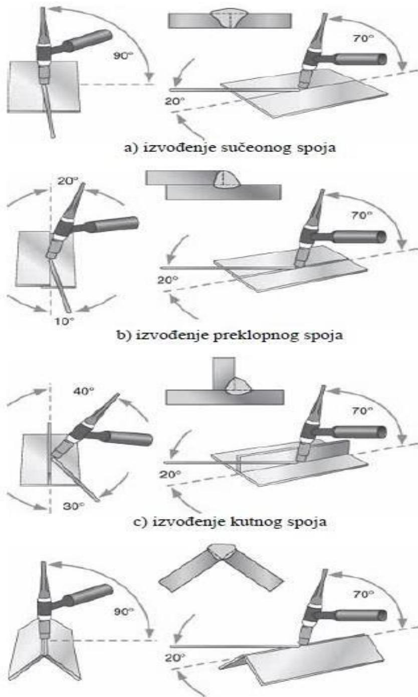
Slika 14. Tehnike izvođenja TIG postupka zavarivanja [11]
