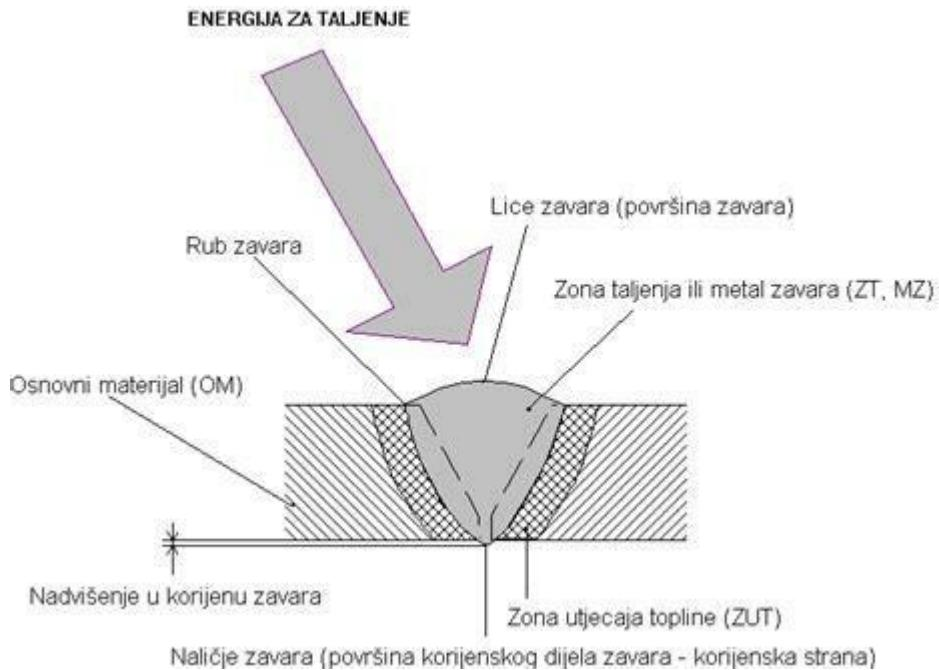
*Slika 1. Zavarivanje taljenjem [2]*
