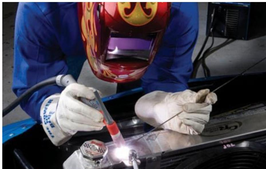
Slika 11. TIG zavarivanje INOX-a istosmjernom strujom [11]
