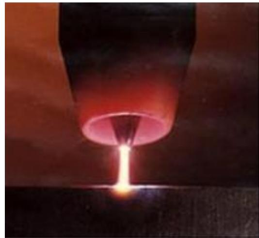
Slika 15. Prikaz sapnice za plazma zavarivanje [3]
