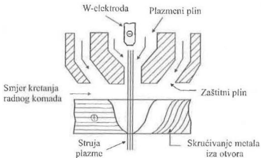
*Slika 17. Shematski prikaz principa zavarivanja tehnikom ključanice [12]*
