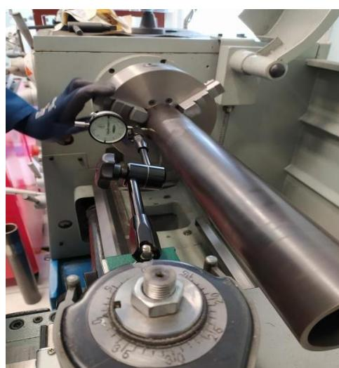
*Slika 29. Ispitivanje kružnosti hladne cijevi prije navarivanja. [17]*
