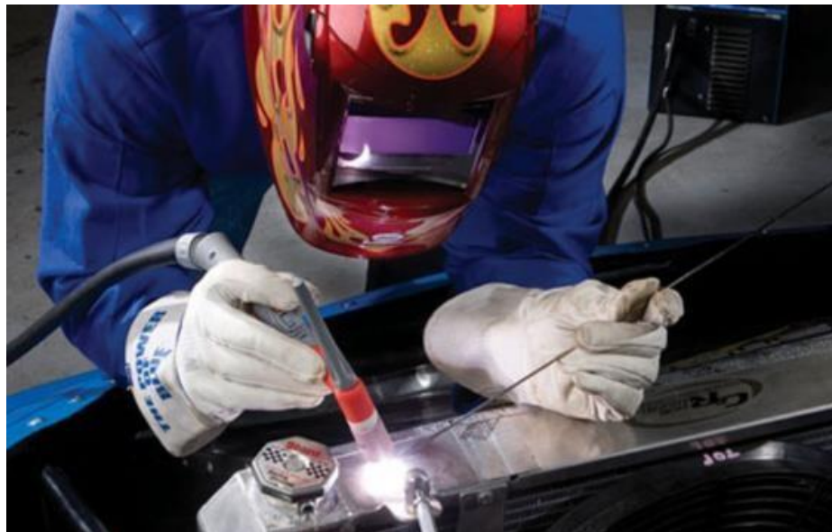
Slika 11. TIG zavarivanje INOX-a istosmjernom strujom [11]
