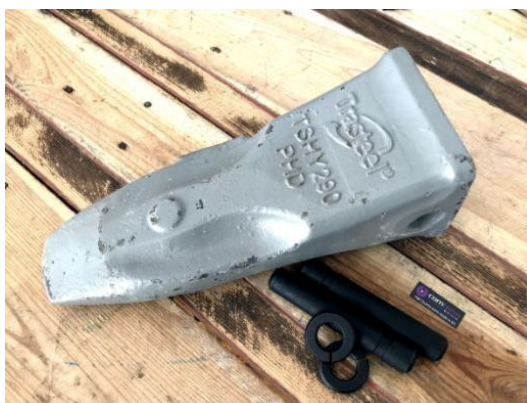
Slika 24. Zub žlice na bageru. [16]
