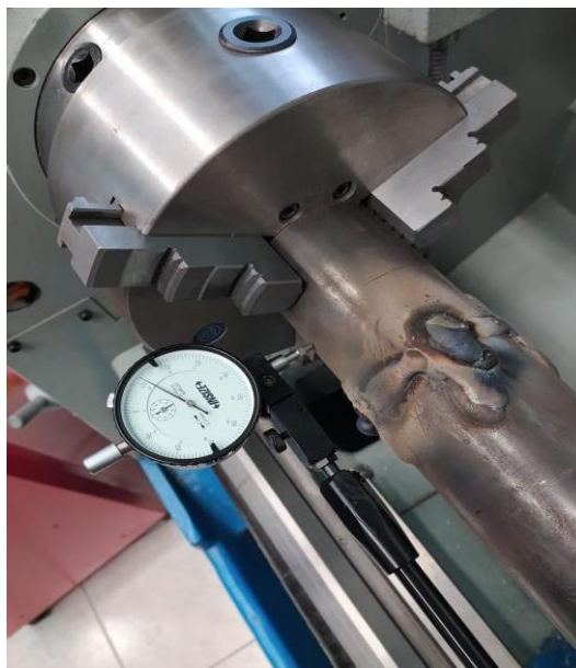
Slika 30. Ispitivanje kružnosti hladne cijevi nakon navarivanja. [17]
