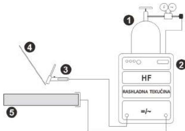
*Slika 13. Shematski prikaz opreme za TIG postupak zavarivanja [11]*
