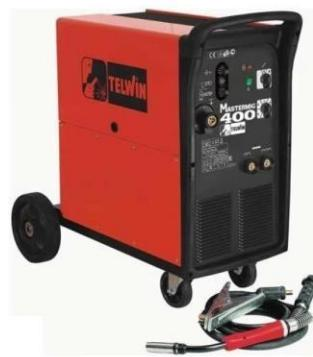
*Slika 10. Primjer aparata za MIG/MAG postupak zavarivanja [9]*
