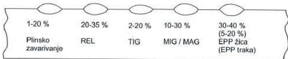
Slika 19. Stupanj miješanja dodatnog sa osnovnim materijalom kod različitih postupaka zavarivanja ili navarivanja [9]
