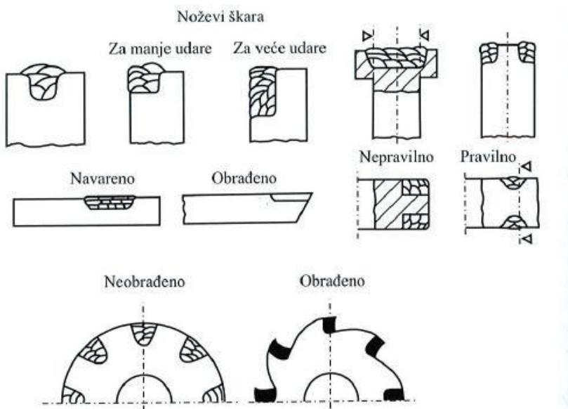
Slika 21. Primjeri navarivanja za izradu alata za strojnu obradu [9]
