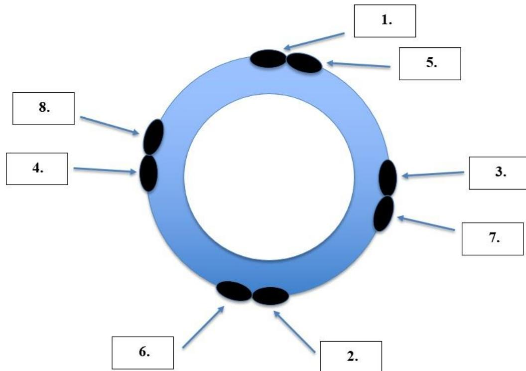
Slika 26. Smjer i raspodjela navara na cijevi [17]
