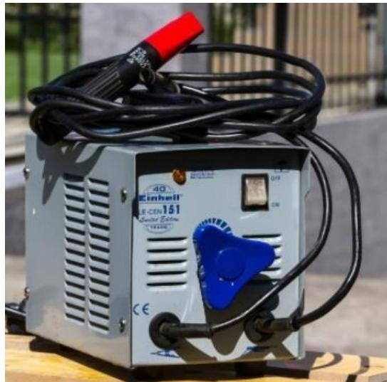
Slika 5. Einhel 151 aparat za REL postupak zavarivanja [8]
