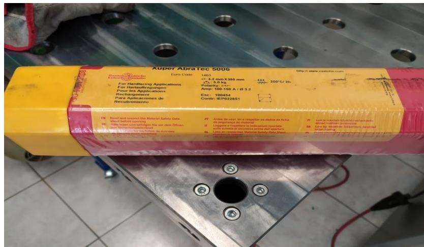
Slika 28. EutecTrode XSUPER AbraTec 5006 bazične elektrode. [17]
