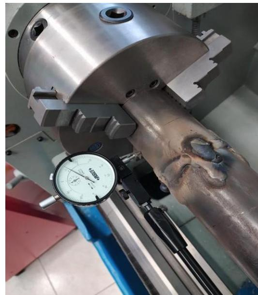
Slika 30. Ispitivanje kružnosti hladne cijevi nakon navarivanja. [17]
