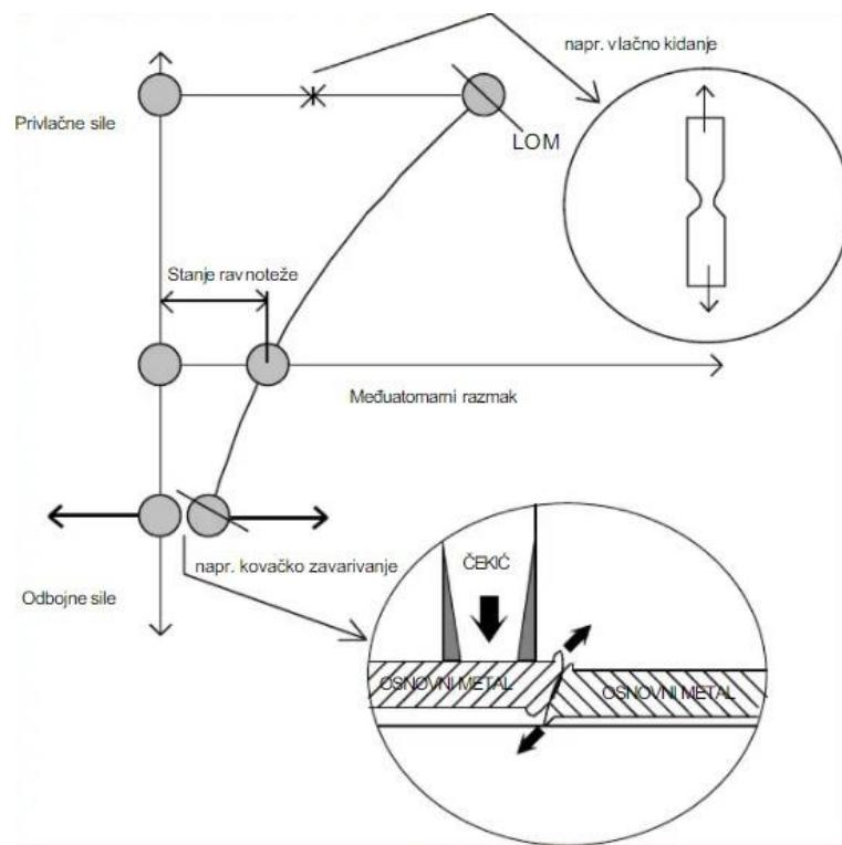
Slika 2. Zavarivanje pritiskom [1]
