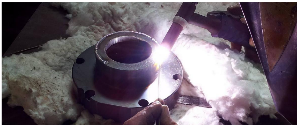
Slika 18. Dograđivanje strojnog dijela [13]
