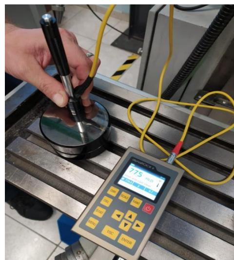
Slika 32. Uredaj za mjerenje tvrdoće i kalibriranje istog. [17]
