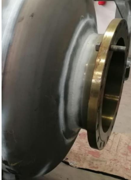
Slika 4-4 Ojačanja na ulaznim otvorima
