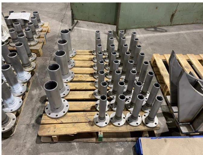
Slika 4-2 Zavarene cijevi i prirubnice
