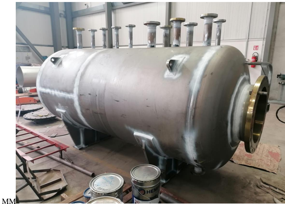
Slika 5-3 Magnetska kontrola posude
