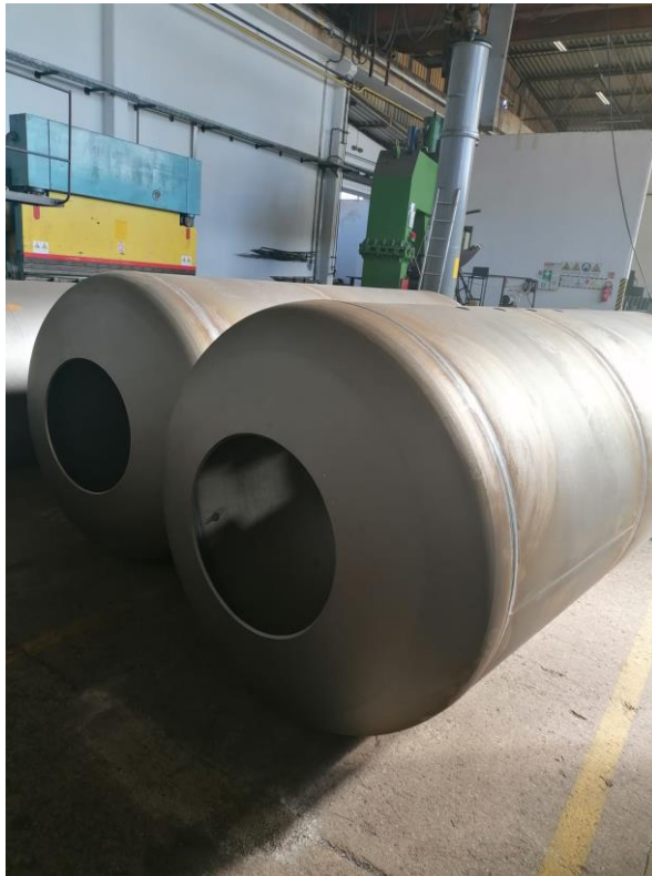
Slika 4-1 Plašt i podnice
