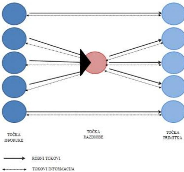
Slika 6. izravno - neizravno upravljanje robnim tokovima u logističkom sustavu s više točaka isporuke i više točaka primitka, te dvije izravne veze točaka isporuke i točaka primitka
