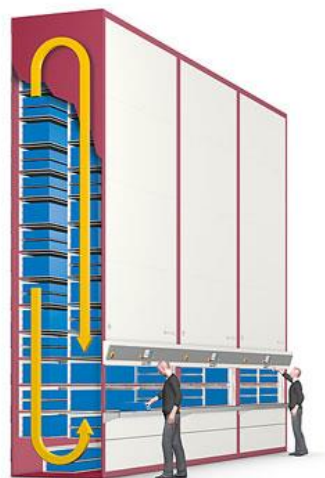
Slika 7. Prikaz vertikalnog karusela
