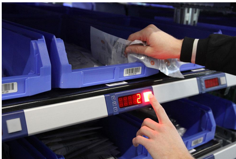
Slika 12. Pick by light komisioniranje
