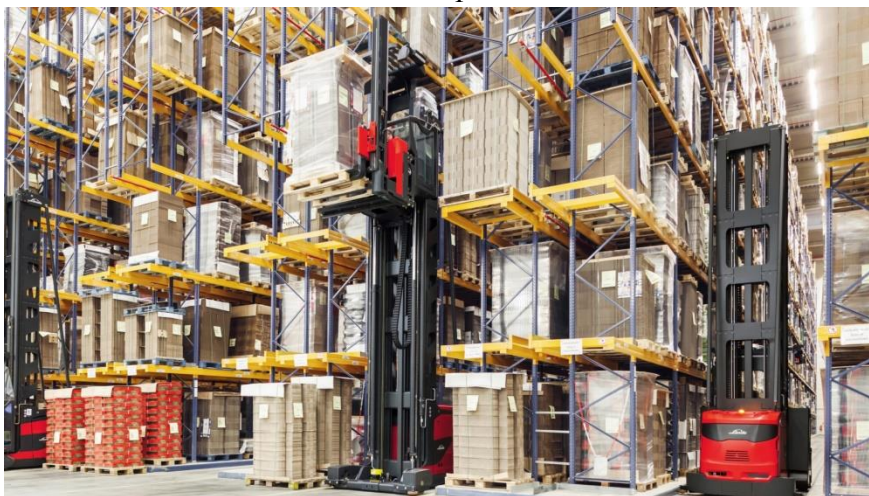
Slika 11. Vrlo uskoprolazni viličari
