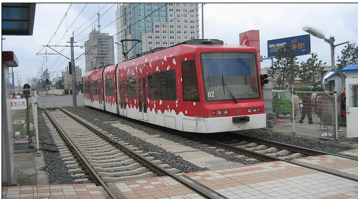
Slika 4.9. Vozilo lake gradske željeznice
