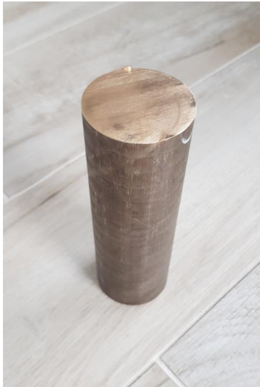
Slika 26. Brončana poluga za izradu utega
