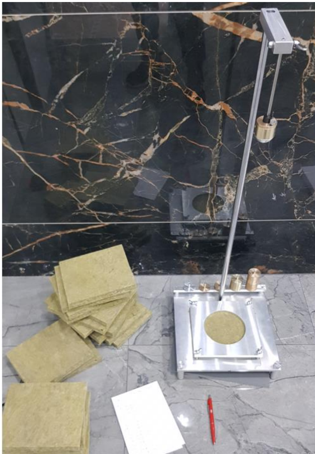
Slika 38. Testiranje kamene vune
