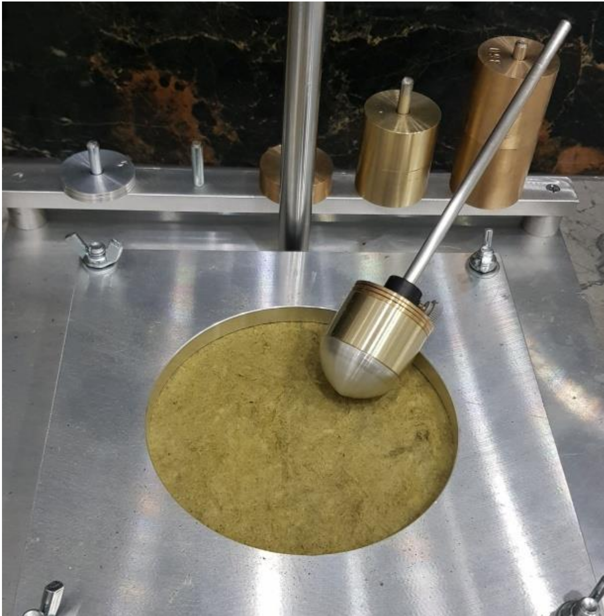
Slika 40. Uteg ne probija uzorak
