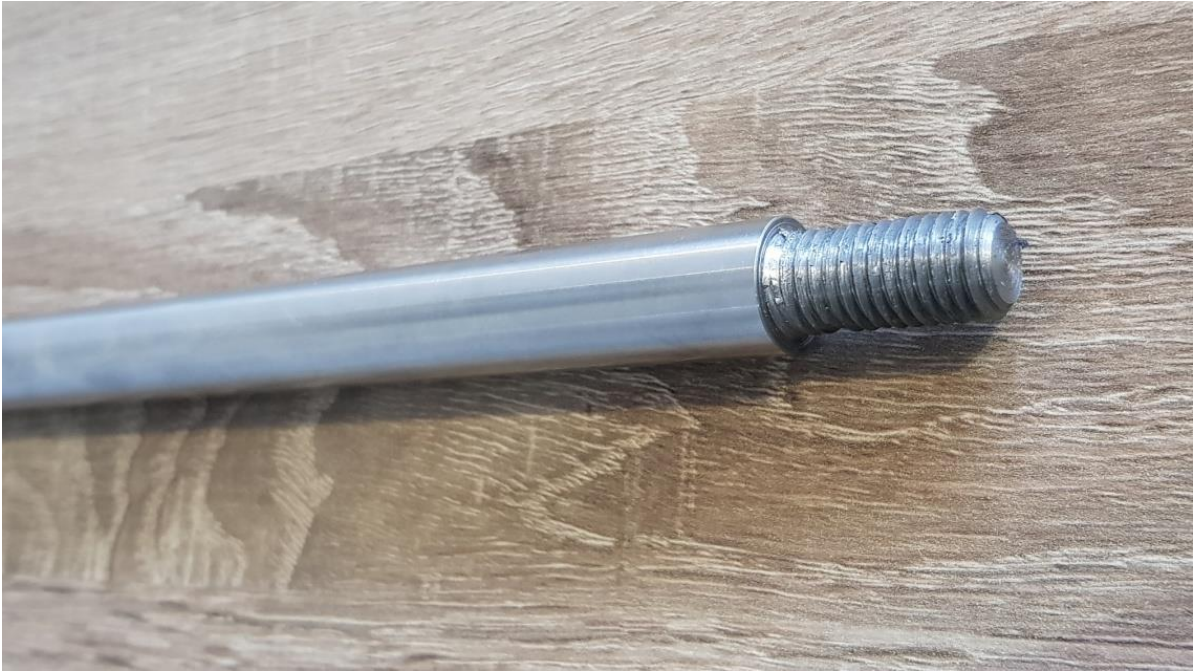
Slika 22. Navoj na potpornom štapu
