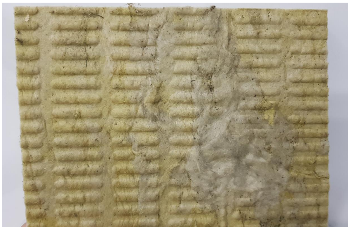
Slika 44. Nepravilnosti u materijalu
