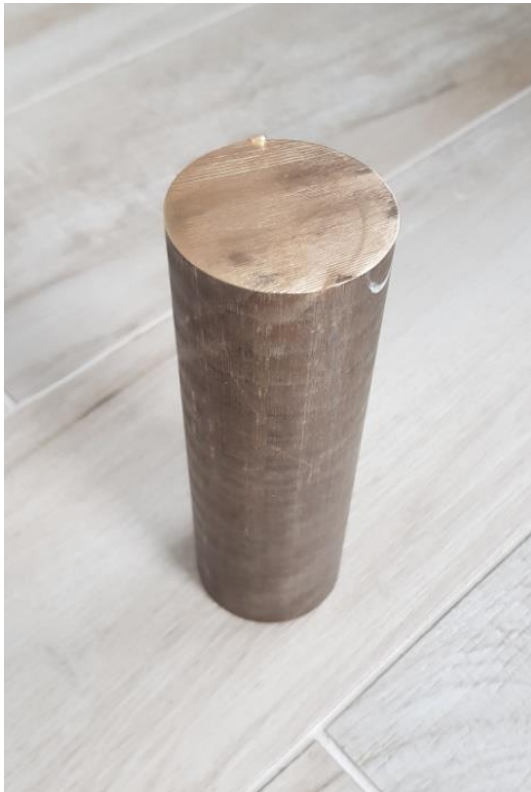
Slika 26. Brončana poluga za izradu utega
