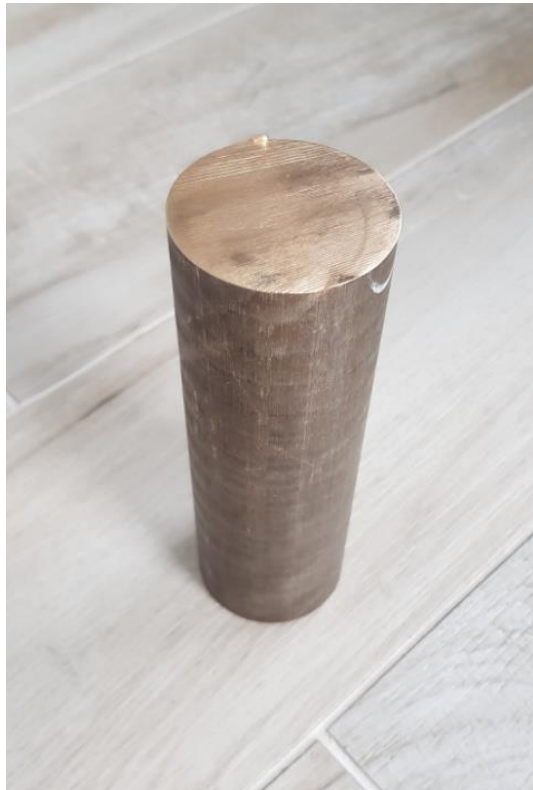
Slika 26. Brončana poluga za izradu utega
