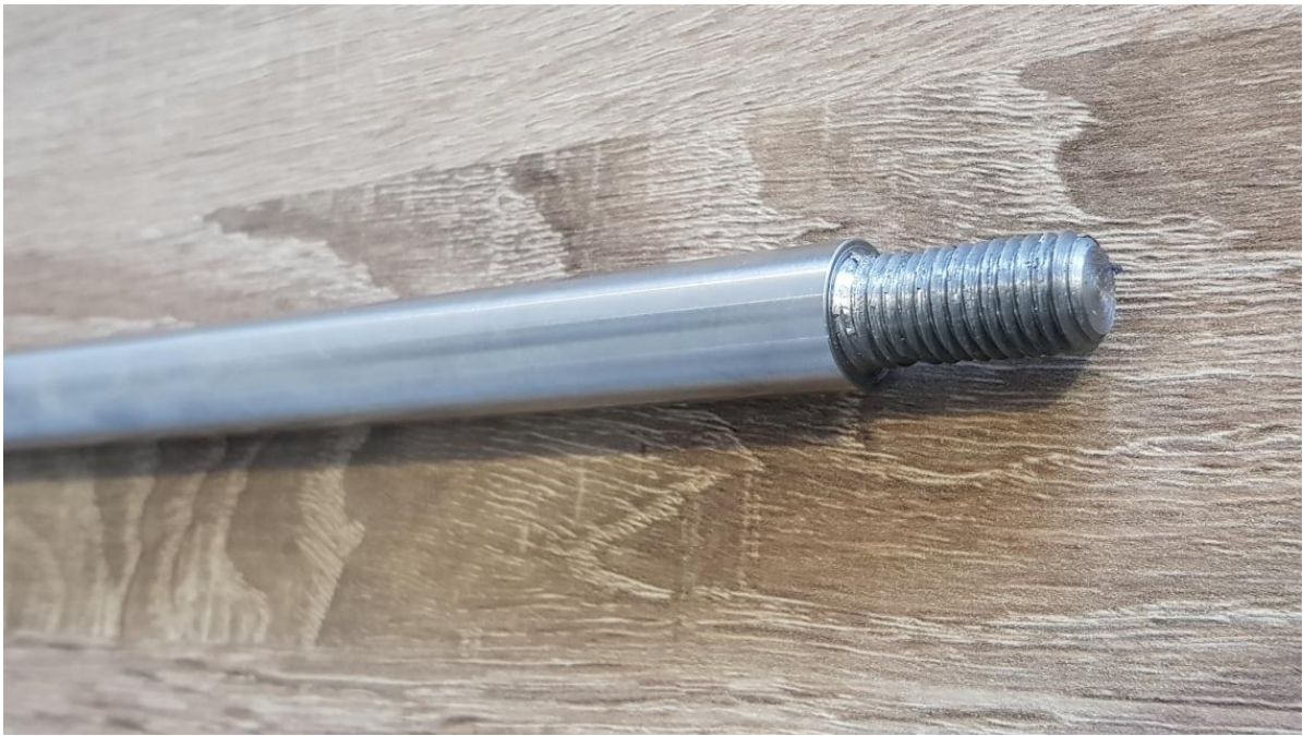
Slika 22. Navoj na potpornom štapu
