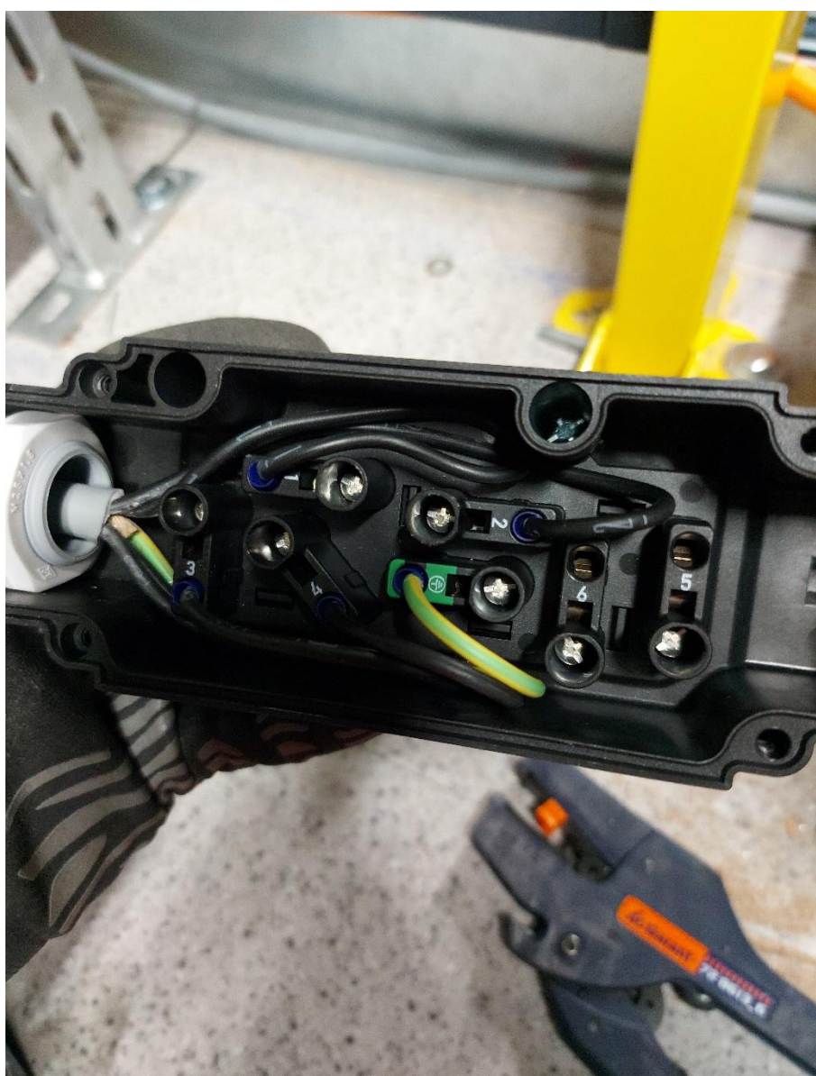
Slika 6.5 Priključni modul sa 5 žica za 400V
