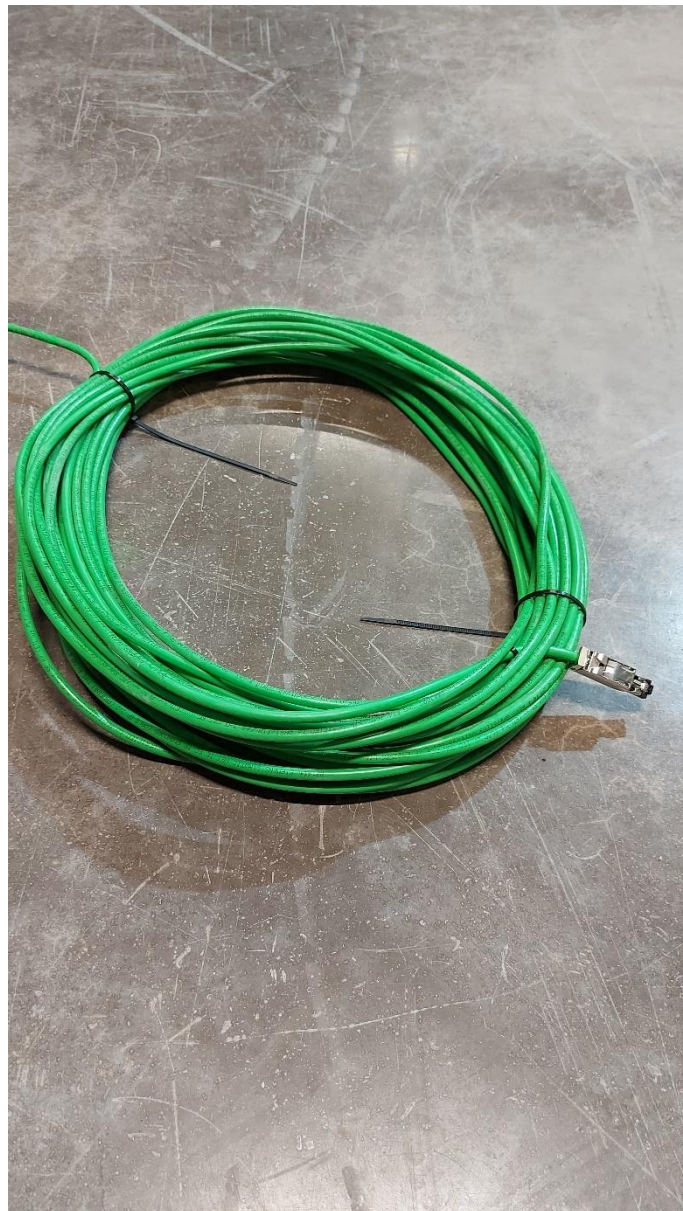
Slika 6.13 Profinet kabel sa M12 utikačem
