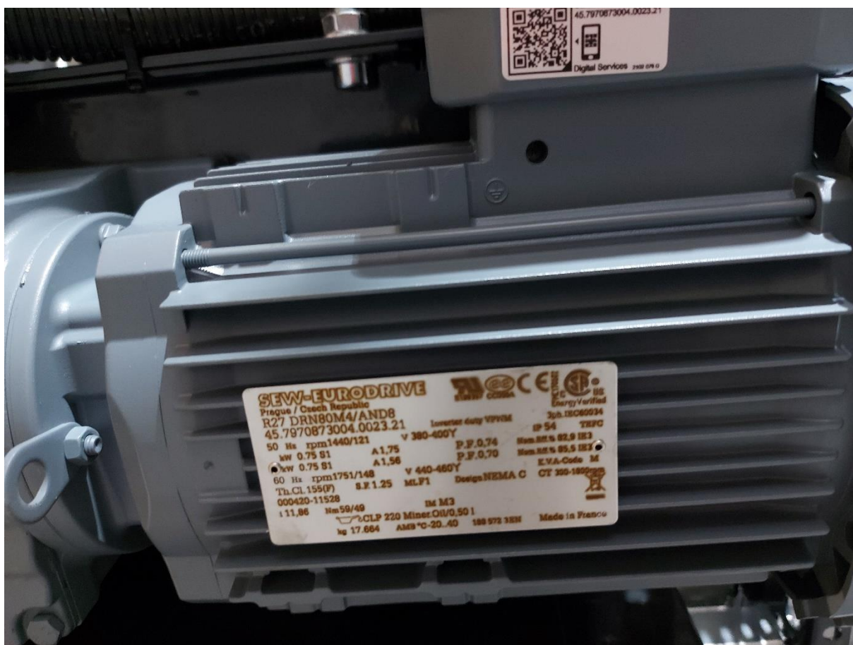
Slika 7.2 Izgled asinkronog motora, te natpisna pločica
