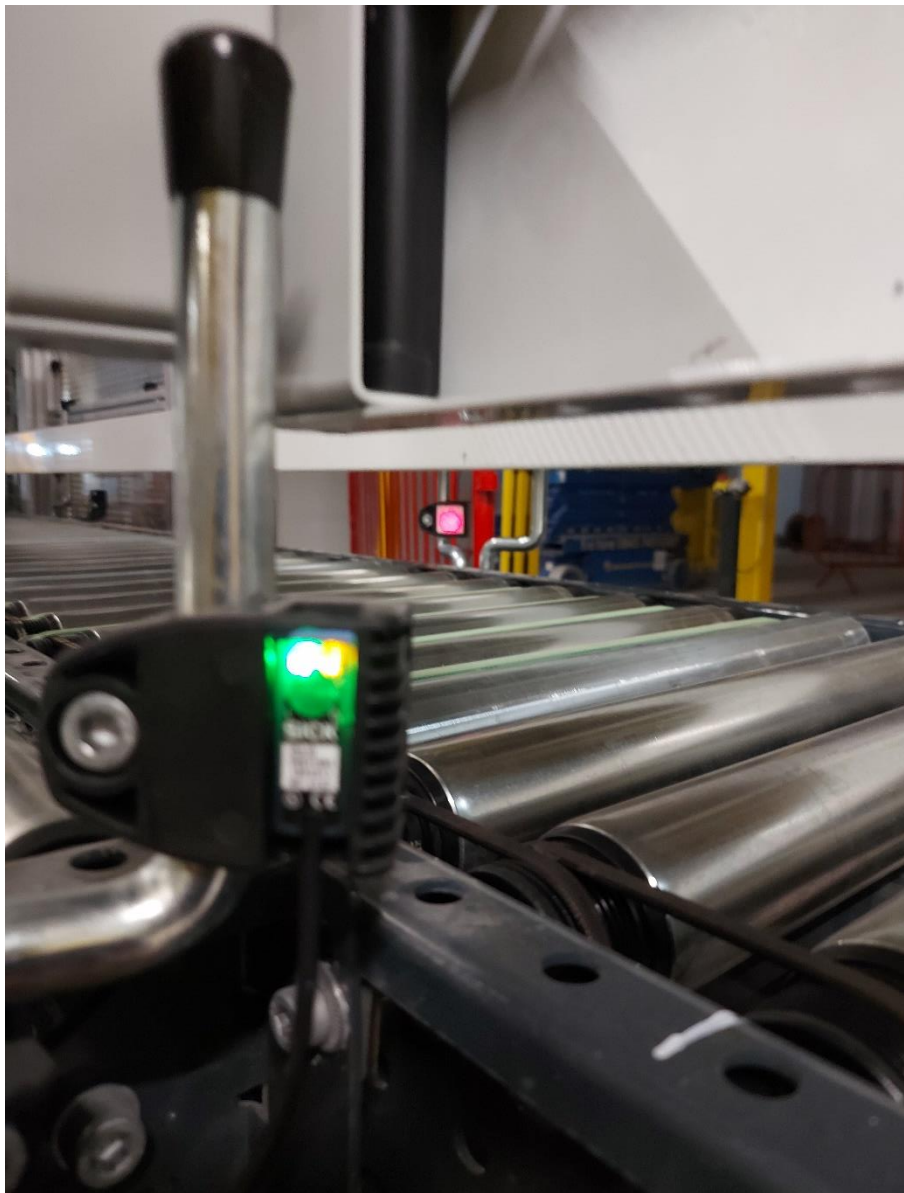
Slika 9.8 Senzor daje povratni signal sa reflektirajuće trake
