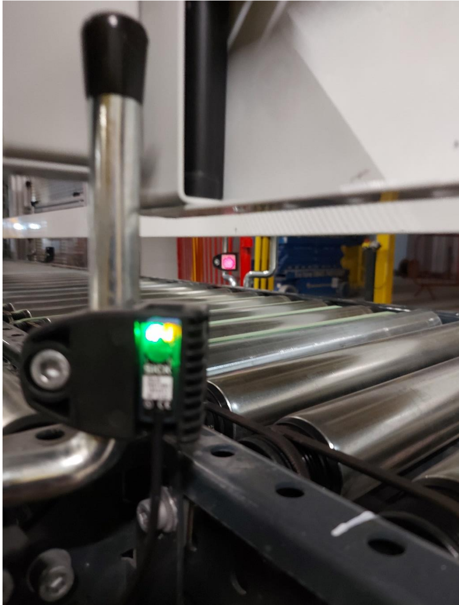
Slika 9.8 Senzor daje povratni signal sa reflektirajuće trake
