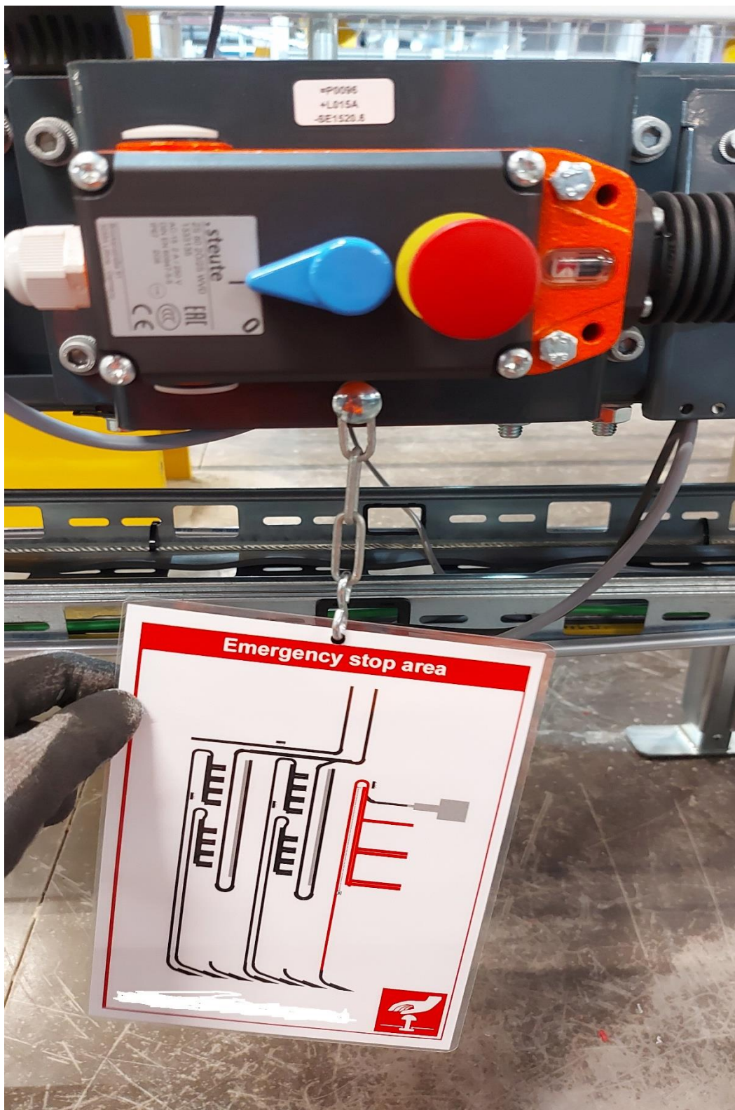
Slika 7.12 Drugi tip tipke u slučaju opasnosti na liniji, ova tipka se nalazi na transportom kanalu linije, tako da radnici brže mogu reagirati u slučaju opasnosti
