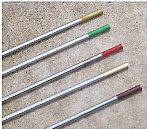
Slika 15. Volframove elektrode označene bojama [18]
