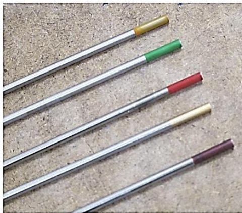
Slika 15. Volframove elektrode označene bojama [18]
