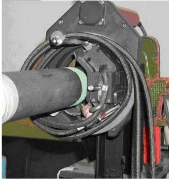
*Slika 27. Orbitalno A –TIG zavarivanje cijevi [11]*
