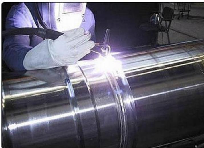
*Slika 6. Zavarivanje cijevi ručnim TIG postupkom [15]*
