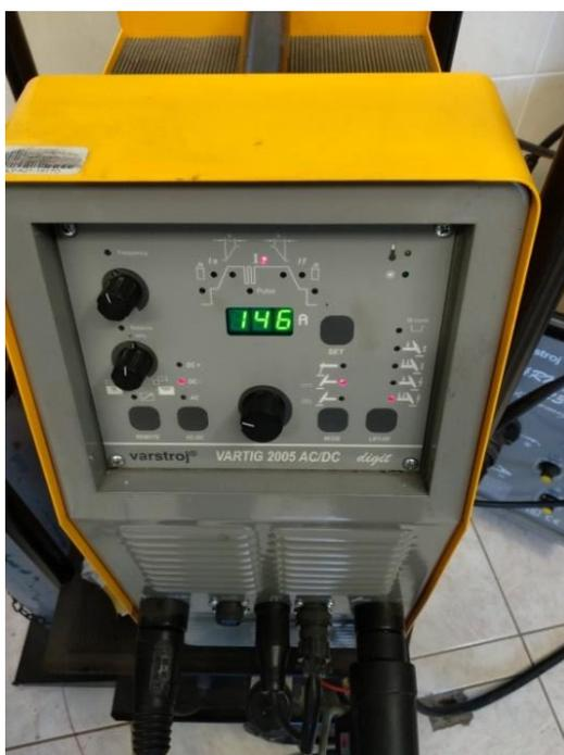
Slika 29. VARTIG 2005 AC/DC uređaj proizvođača Varstroj
