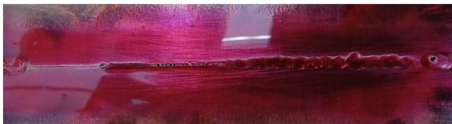
*Slika 39. Slike zavara nakon nanošenja penetranta*
