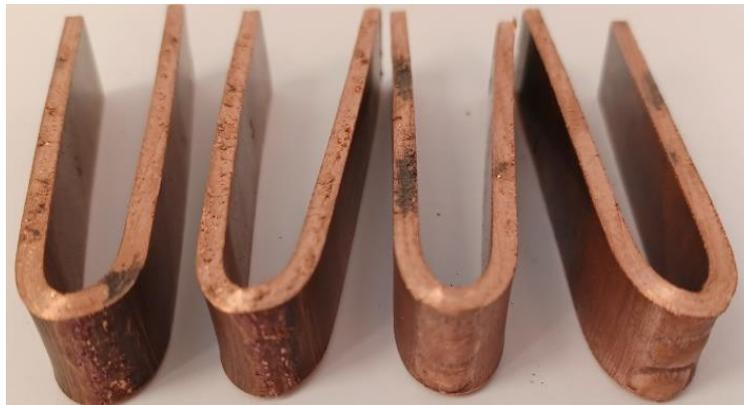
*Slika 43. Savijanje uzoraka*
