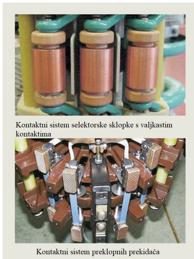
Slika 4.14 OLTC s wolfram-bakrenim sustavom lučnih kontakata za mineralno transformatorsko ulje [8]
