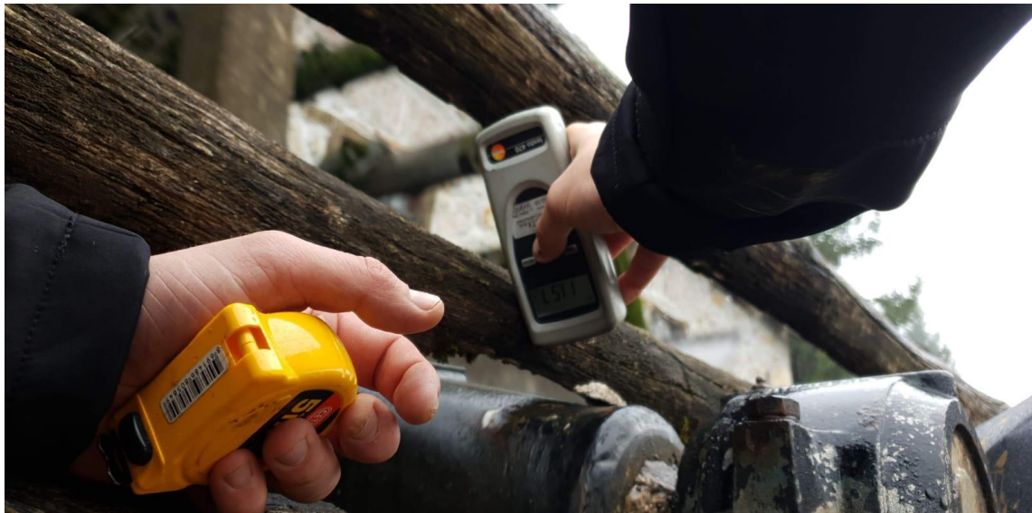
Slika 35. Mjerenja broja okretaja pomoću uređaja Tachometer [3]
