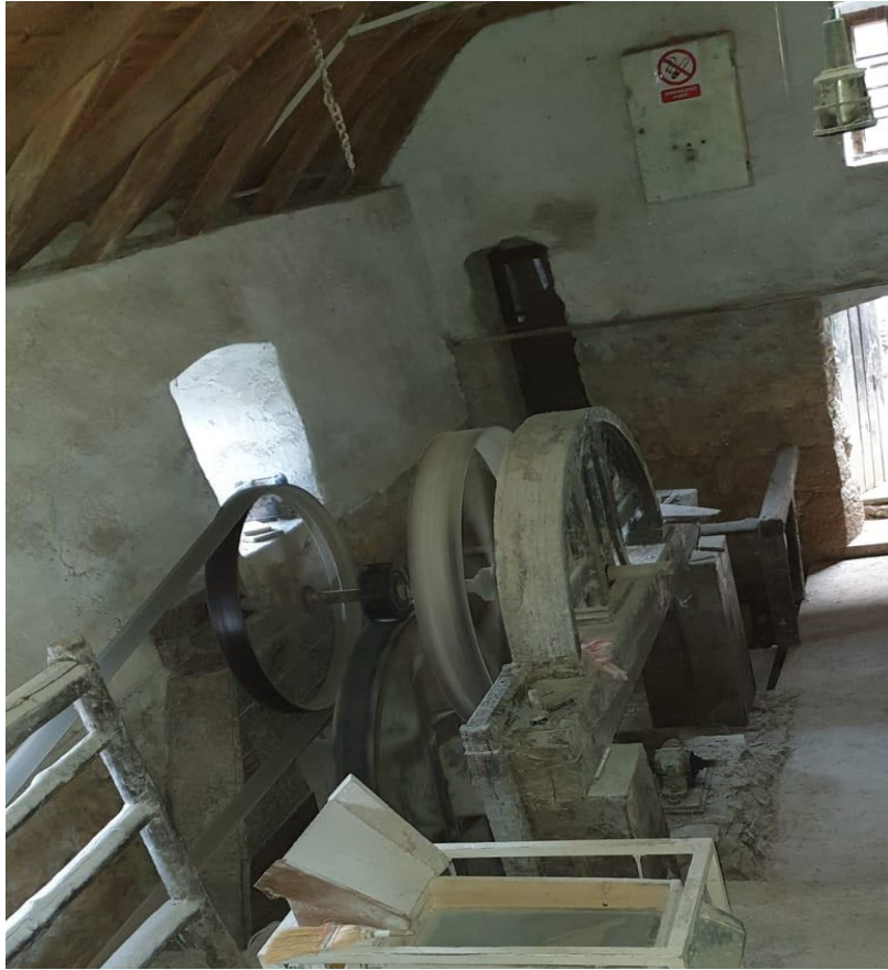
Slika 21. Mehanizam prijenosa sile s mlinskog kola na kameni žrvanj [3]
