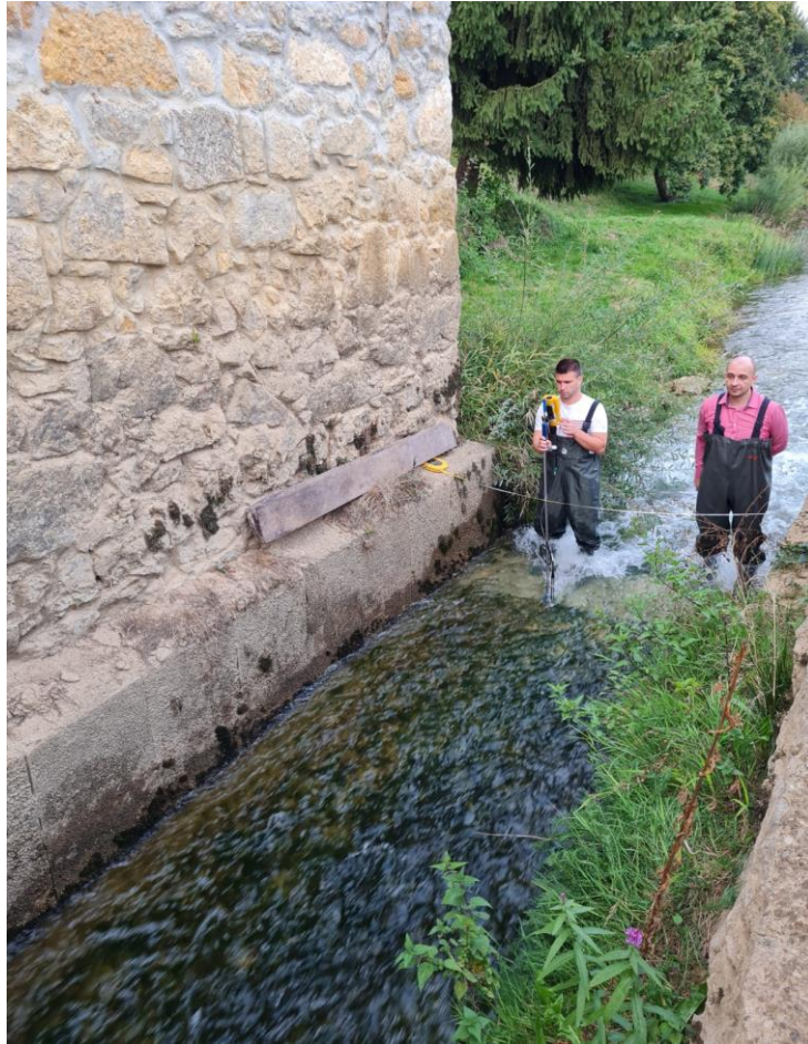
Slika 28. Mjerenje brzine vode u kanalu Matinog mlina pomoću FlowTracker-a [3]
