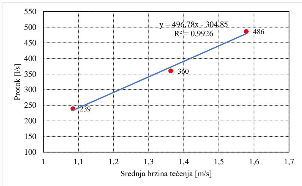
Slika 50. Grafički prikaz ovisnosti protoka o brzini tečenja [3]
