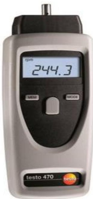
Slika 26. Testo 470 Tachometer [12]
