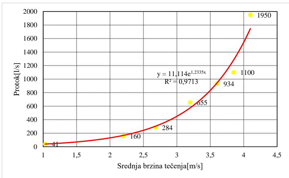
Slika 53. Grafički prikaz ovisnosti protoka i brzine tečenja [3]
