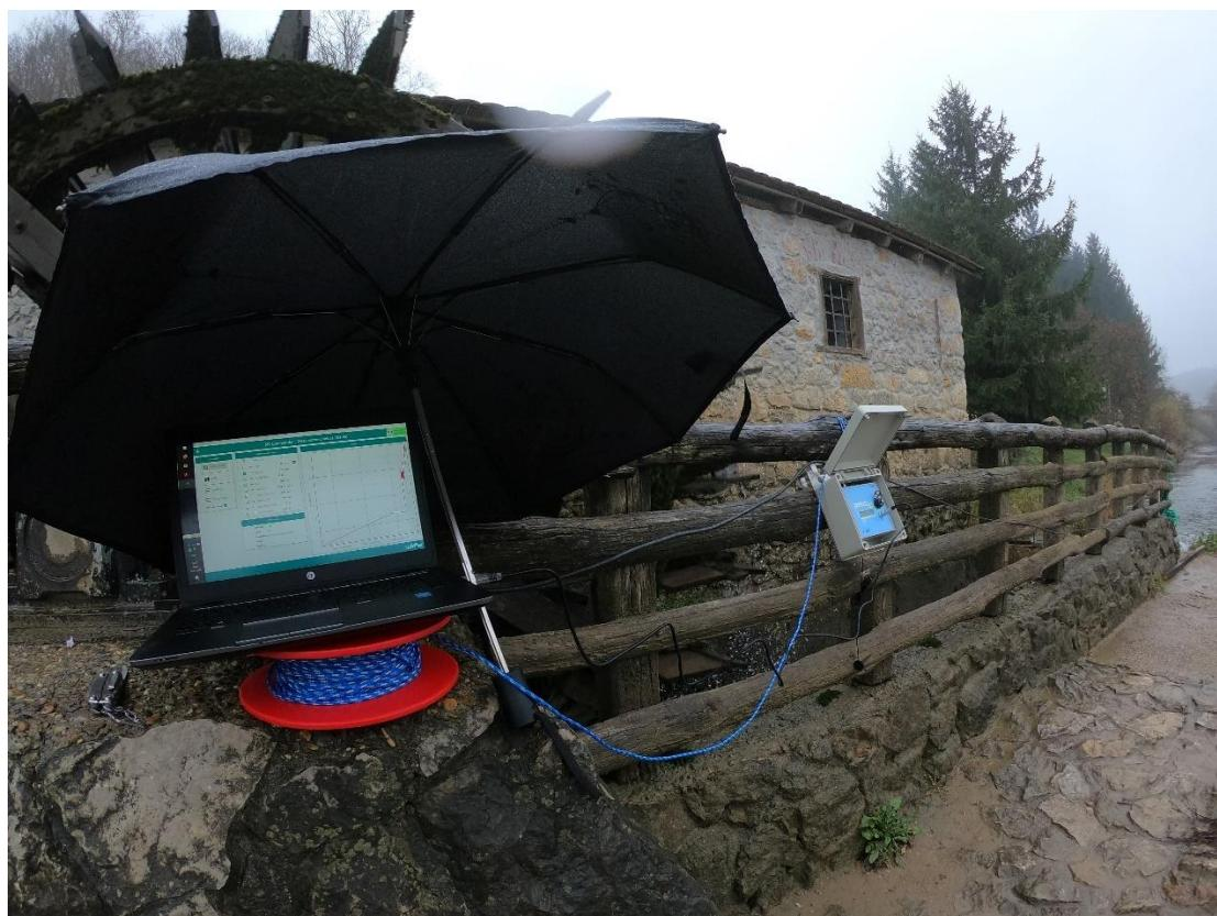
Slika 33. Analiza i obrada podataka SQ-R Flow Meter [3]
