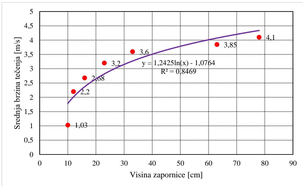
Slika 52. Grafički prikaz ovisnosti brzine tečenja o visini zapornice [3]
