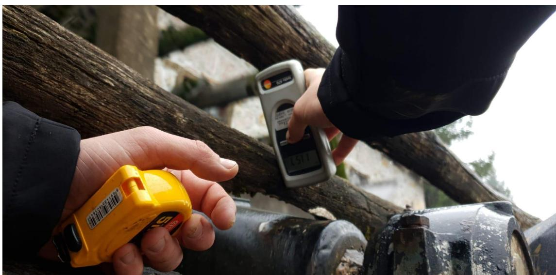
Slika 35. Mjerena broja okretaja pomoću uređaja Tachometer [3]
