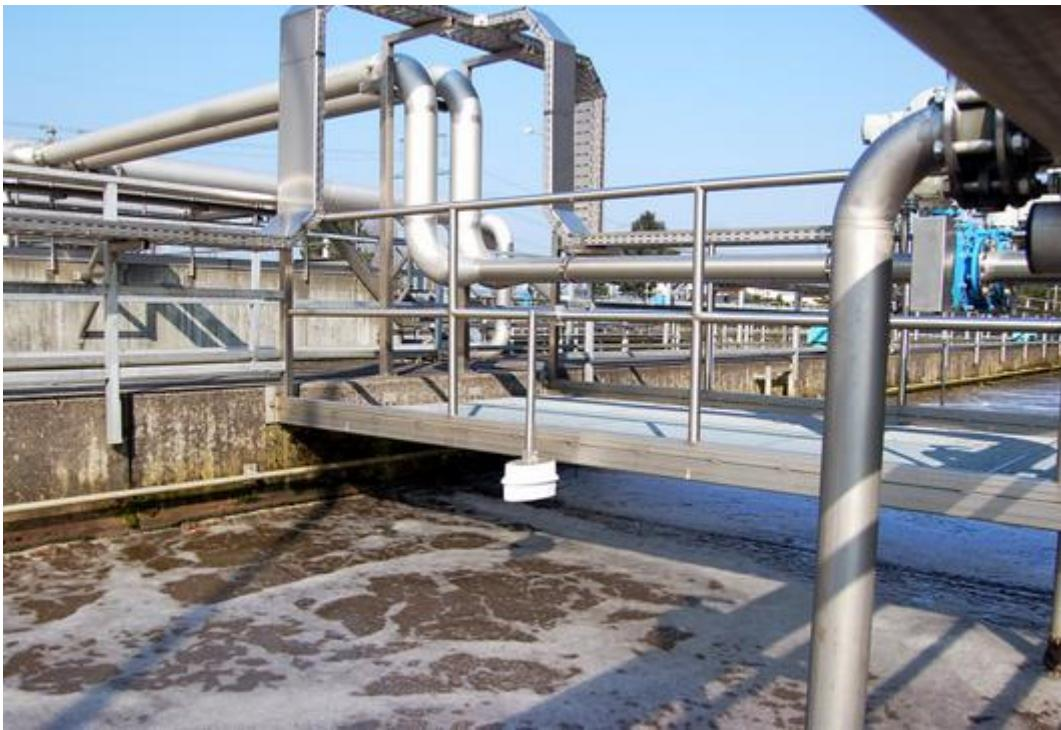
Slika 24. Mjerenje pomoću uređaja SQ-R Flow Meter na uređaju za pročišćavanje otpadnih voda [11]
