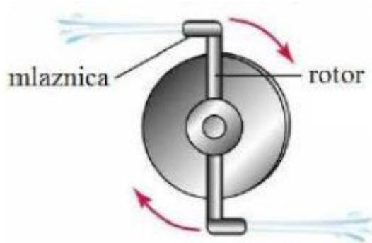
Slika 4. Reakcijska turbina [4]
