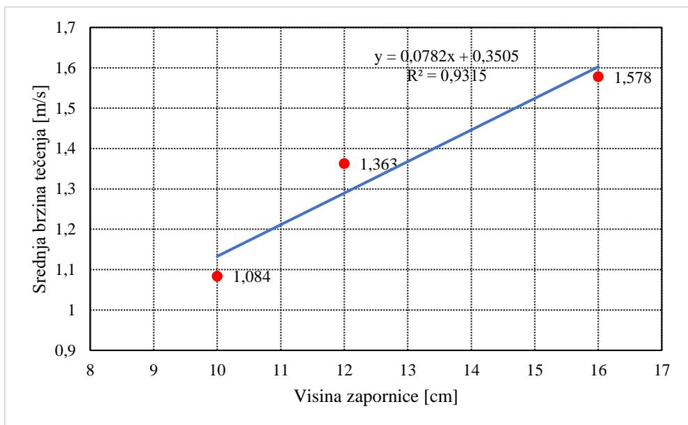
Slika 49. Grafički prikaz ovisnosti brzine tečenja o visini zapornice [3]
