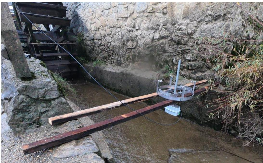
Slika 25. Prikaz montaže i mjerena sa SQ-R Flow Meter [3]
