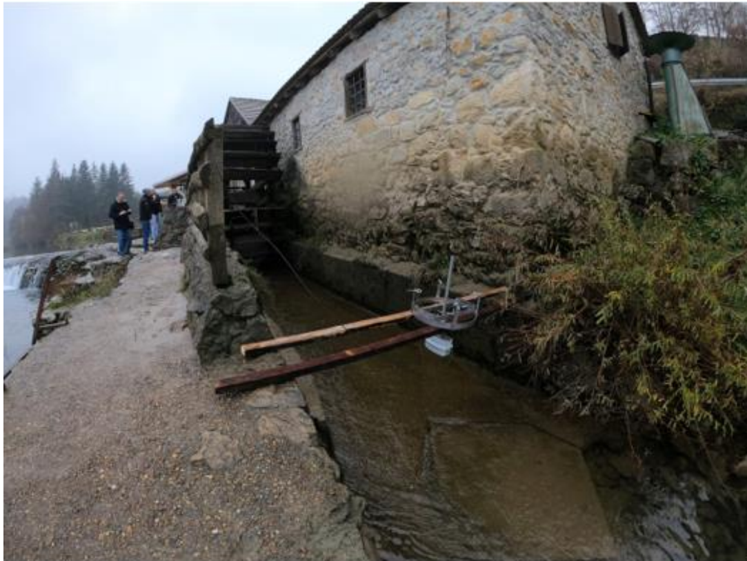
Slika 32. Postavljanje SQ-R Flow Meter [3]
