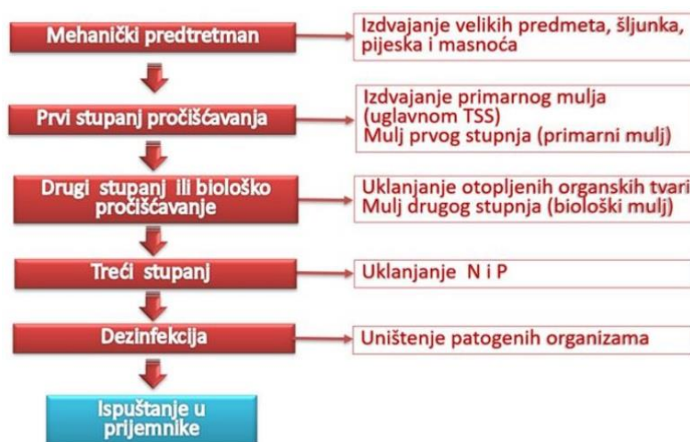
Slika 2. Stupnjevi i postupci pročišćavanja otpadne vode [2]
