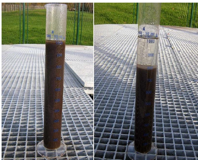
Slika 12: Voda iz aeracijskog bazena (lijevo), pročišćena voda nakon 20 minuta taloženja (desno) [11]
