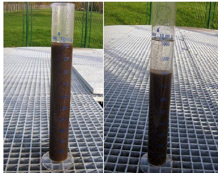
Slika 12: Voda iz aeracijskog bazena (lijevo), pročišćena voda nakon 20 minuta taloženja (desno) [11]
