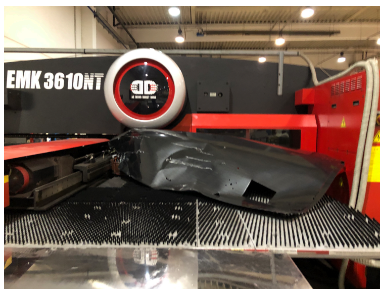
Slika 3.12 Uništen lim kao posljedica zapinjanja
