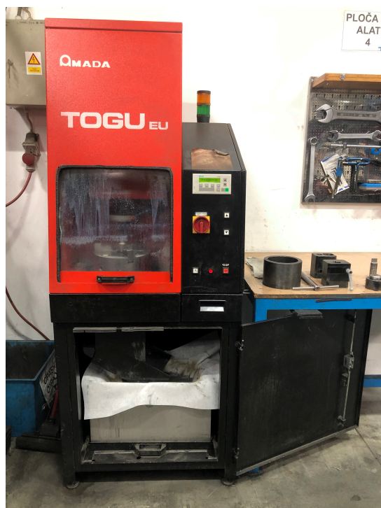
Slika 3.11 CNC brusilica AMADA TOGU EU
