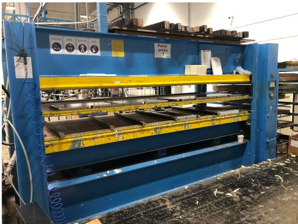
Slika 3.18 Hidraulična preša ITALPRESE 2
