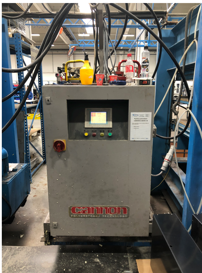
Slika 3.16 Punilica poliuretana CANON A-BASIC 40
