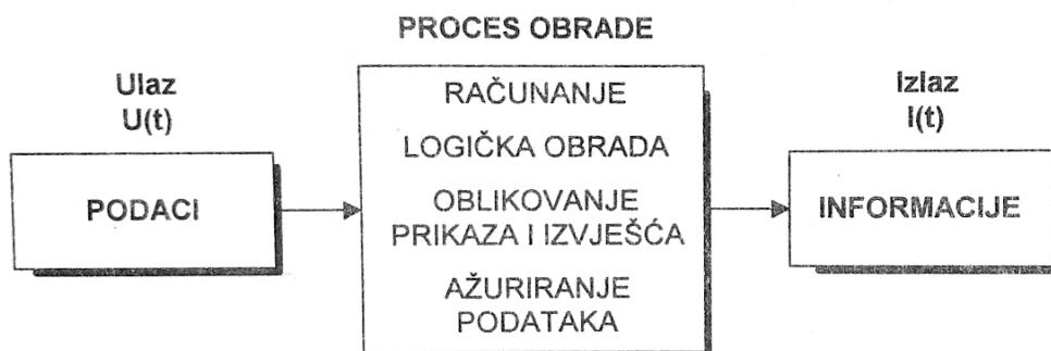
Slika 2.1 Proces obrade u informacijskom sustavu [1]
