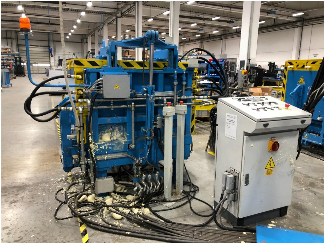
Slika 3.19 Hidraulična preša MANNI PMC 64 T
