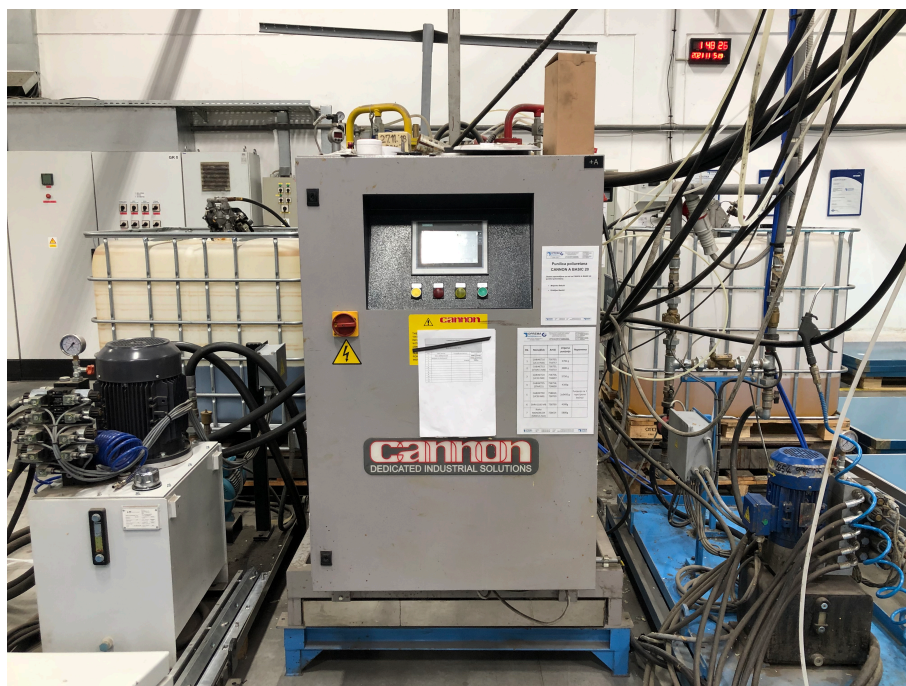
Slika 3.15 Punilica poliuretana CANNON A-BASIC 20
