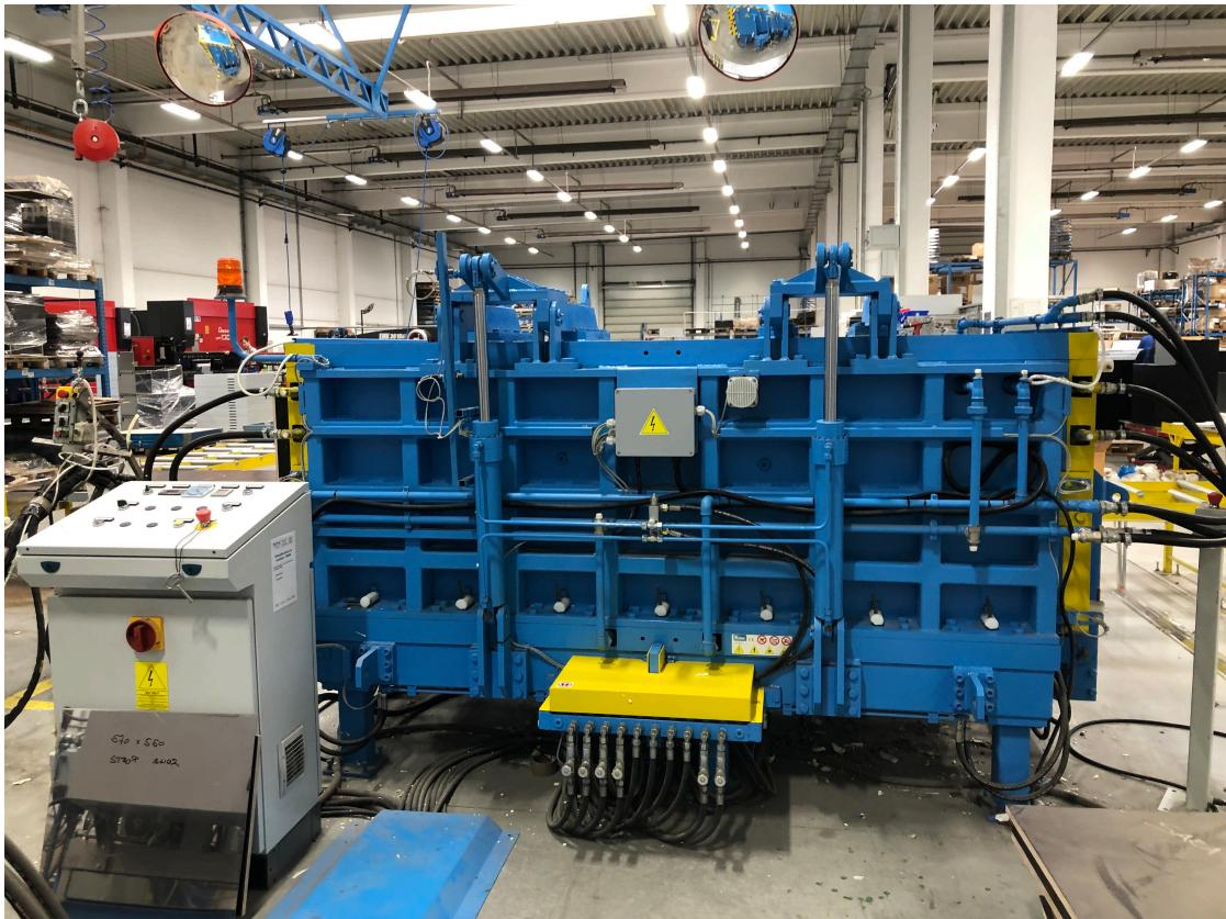
Slika 3.20 Hidraulična preša MANNI PMC 300M
