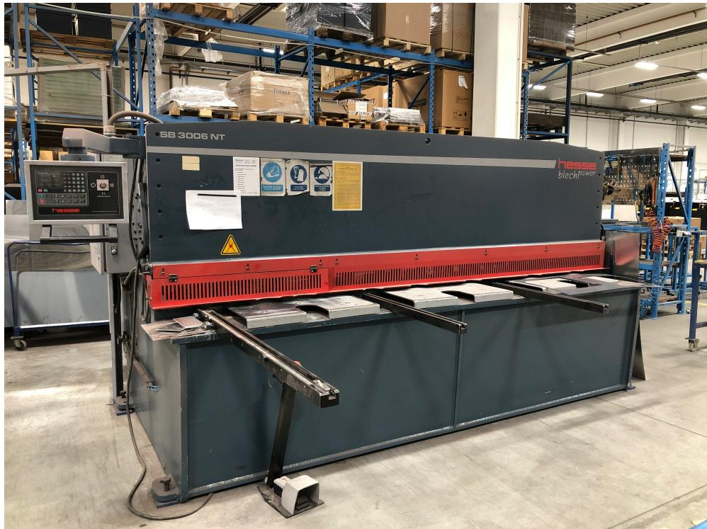
Slika 3.14 Hidraulične škare HESSE SB 3006 NT
