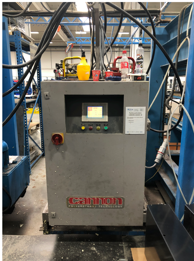
Slika 3.16 Punilica poliuretana CANON A-BASIC 40
