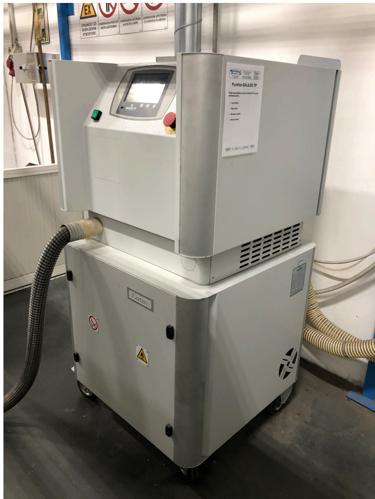
Slika 3.21 Punilica rashladnog sredstva GALILEO TP CERTUS C12
