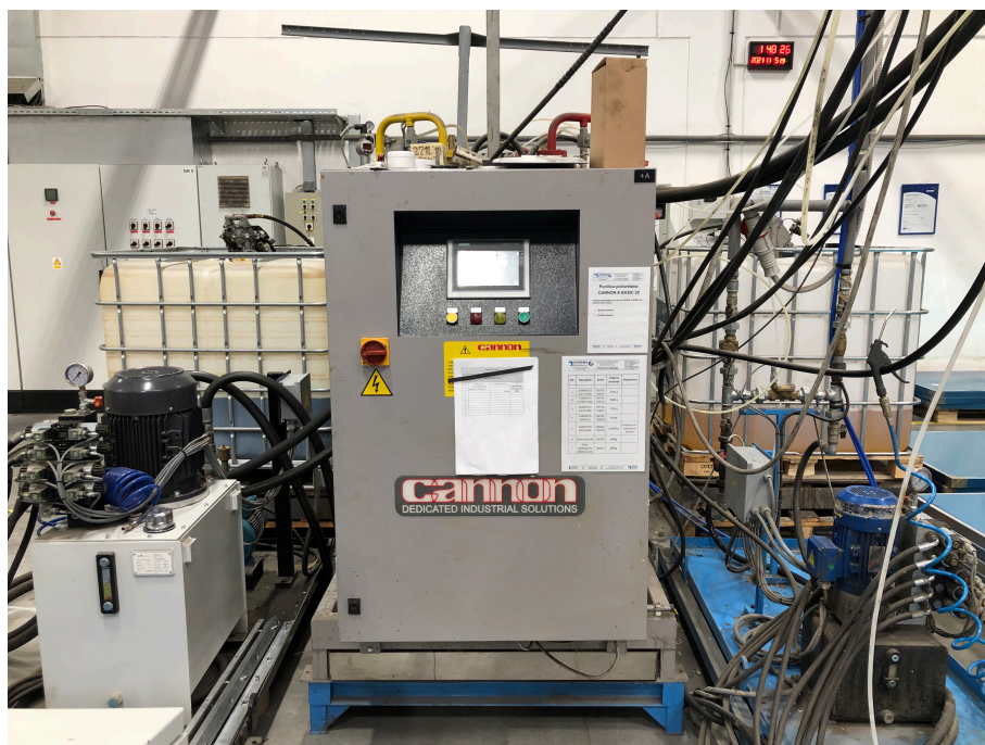
Slika 3.15 Punilica poliuretana CANNON A-BASIC 20
