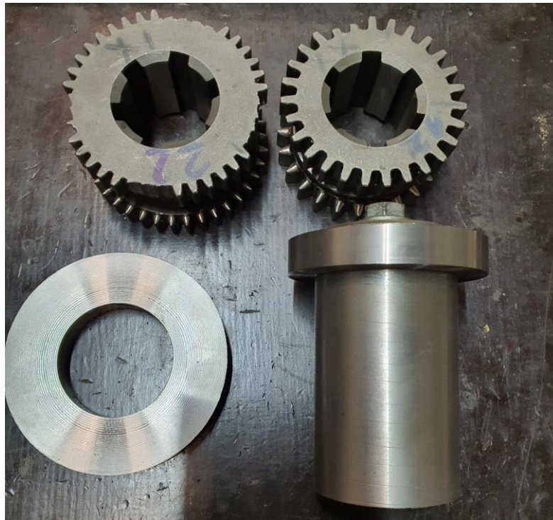
Slika 7.3 Istokareni zupčanici i prihvat za glodanje
