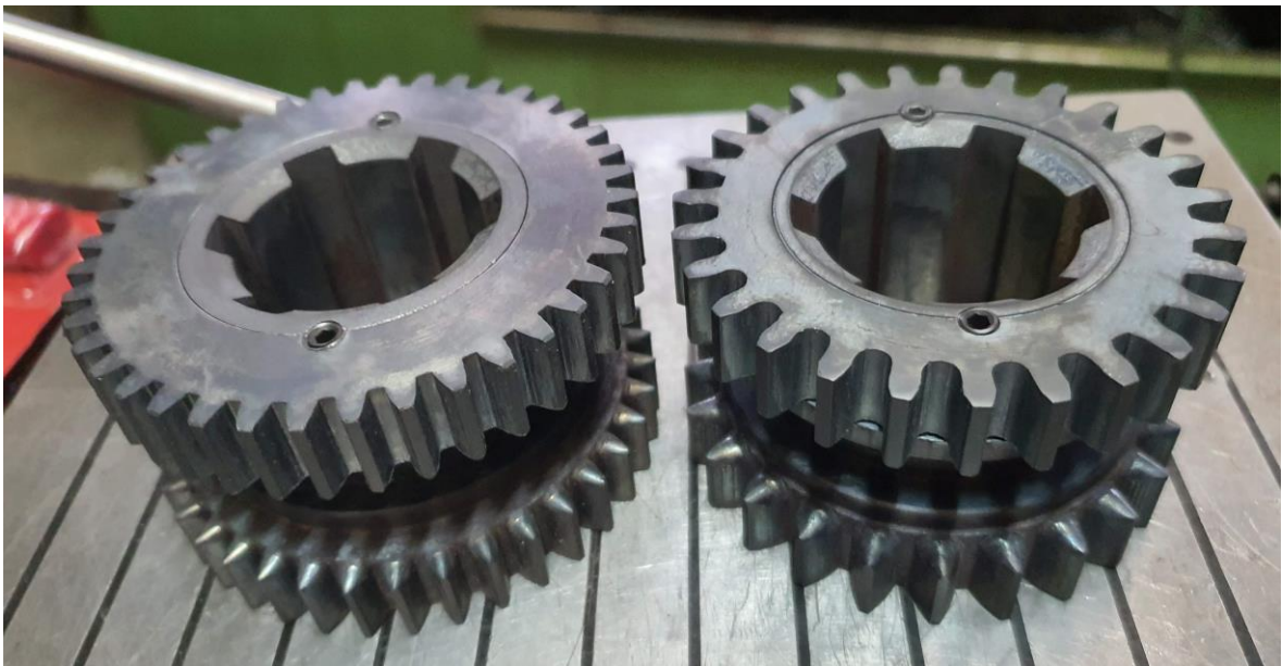
Slika 8.3 Poboljšani zupčanici prije montaže
