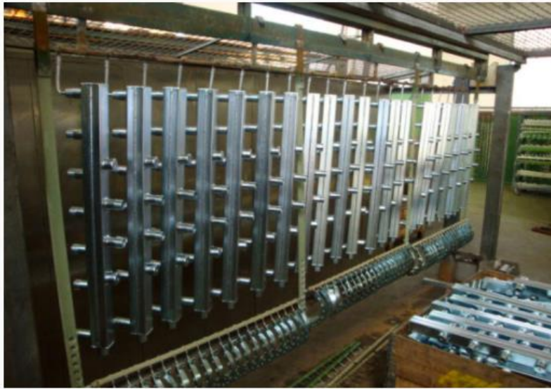
Slika 52. Primjer galvanski pocinčanih pozicija[11]
