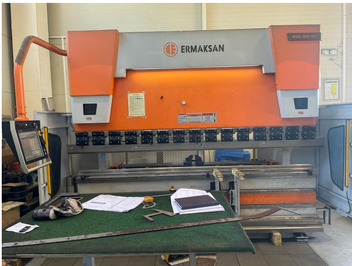
Slika 47. Apkant preša proizvođača Ermaksan
