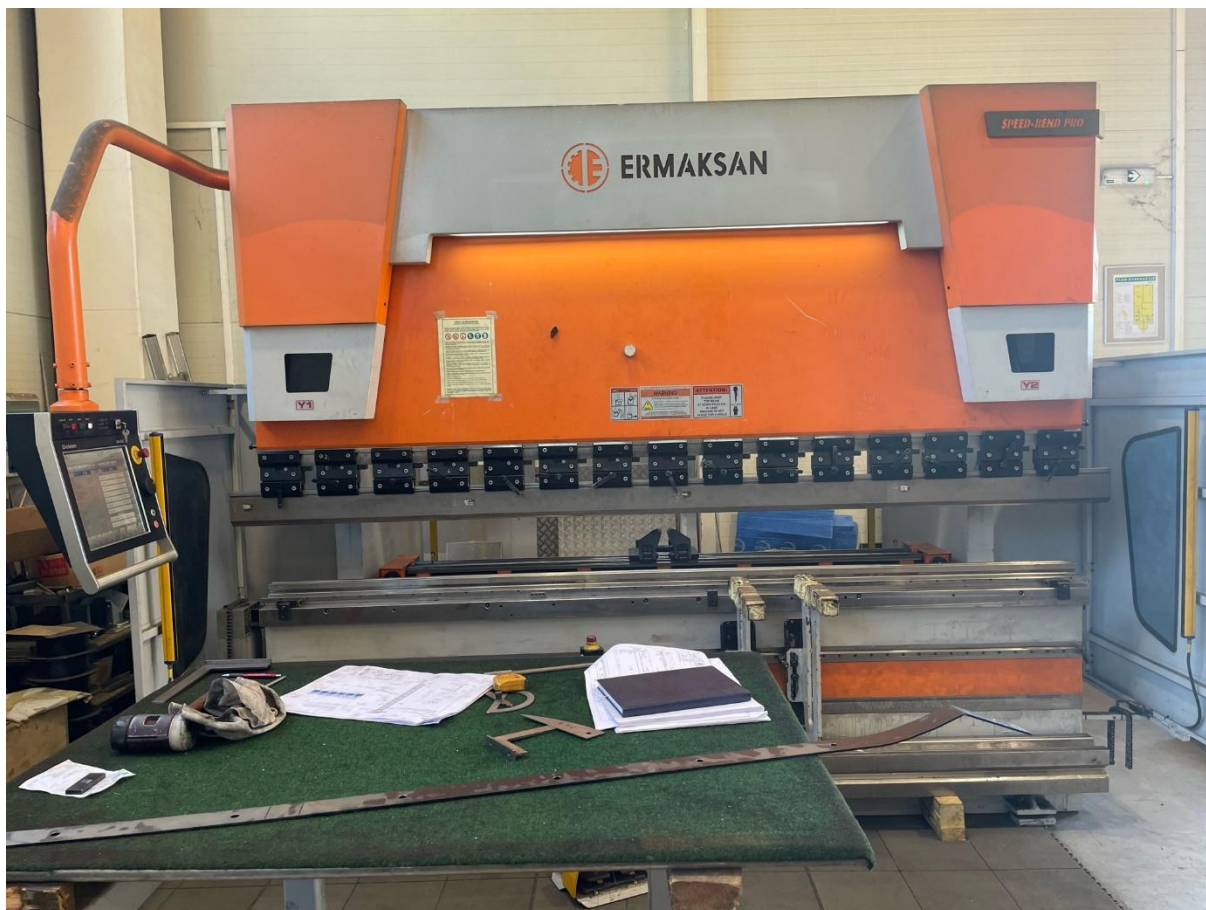
Slika 47. Apkant preša proizvođača Ermaksan
