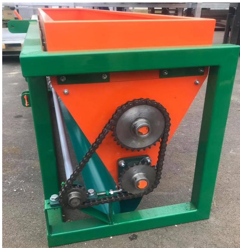
Slika 56. Kalcifikator - bočna stranica kod prijenosa
