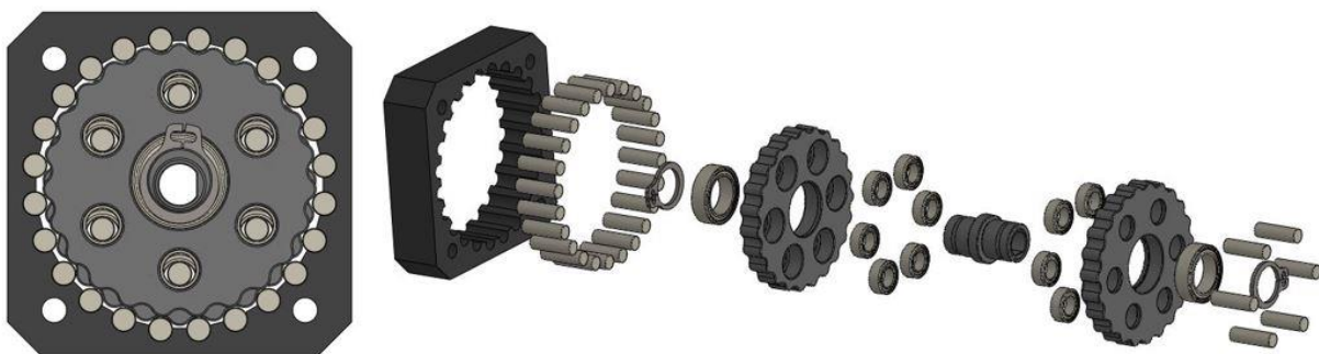
Slika 21. Model cikloidnog reduktora šestog zgloba robotske ruke
