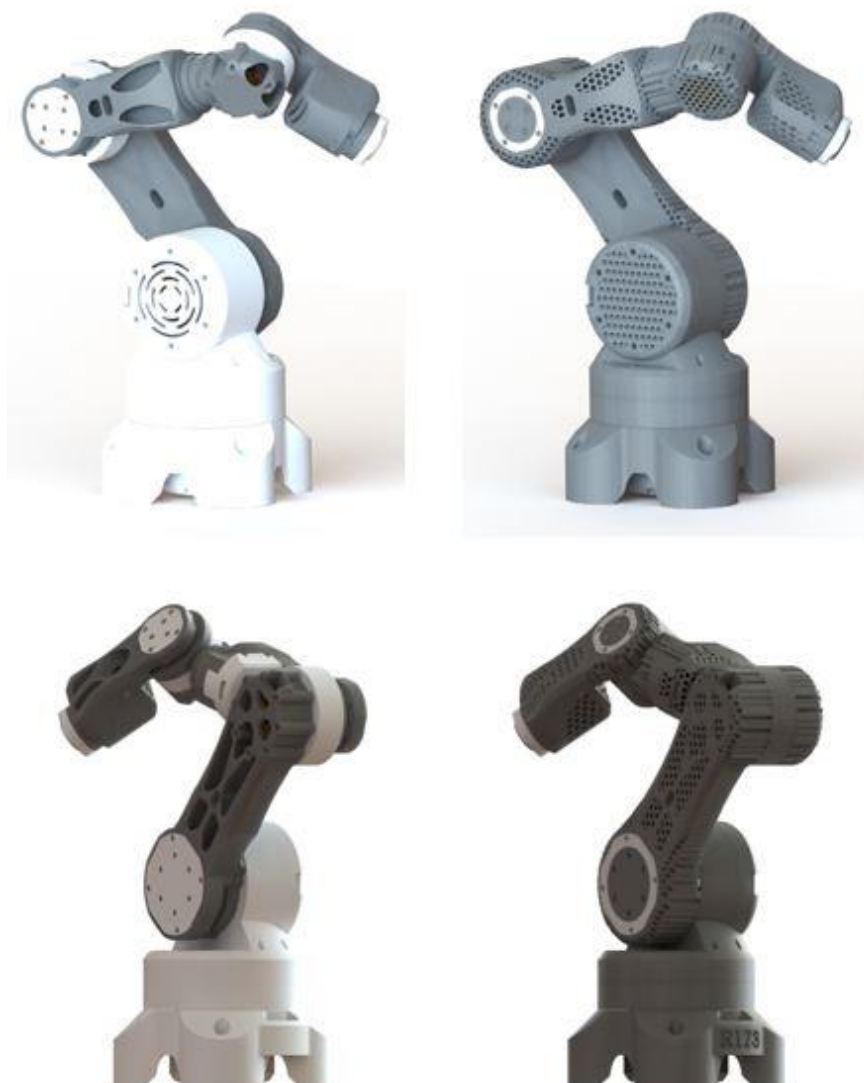
Slika 44. Model robotske ruke nakon optimizacije (lijevo) i nakon finalnog redizajna (desno) (iz vlastite arhive: 01.12.2021. 22:31)
