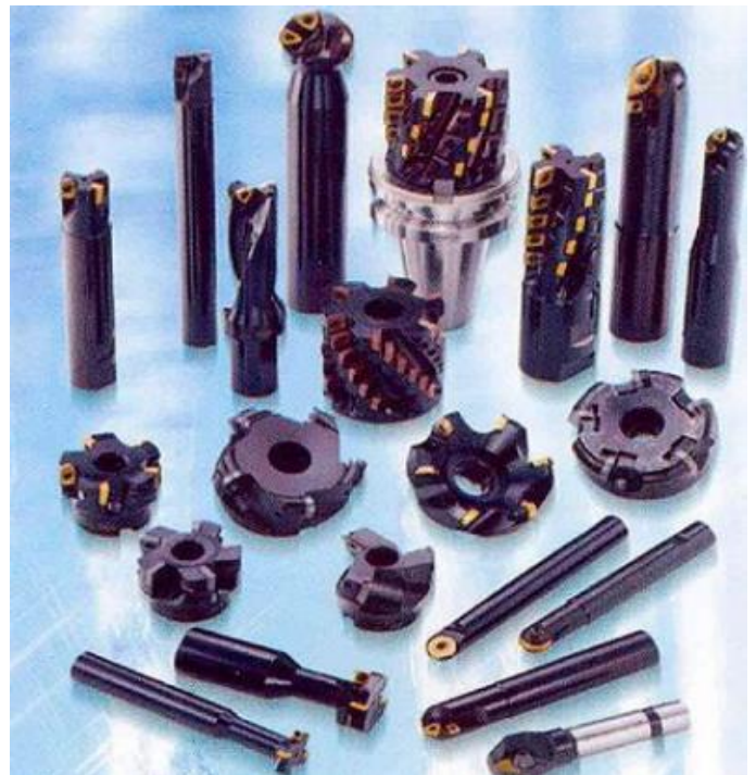
Slika 3.4 Glodala s umetnutim reznim oštricama [2]
