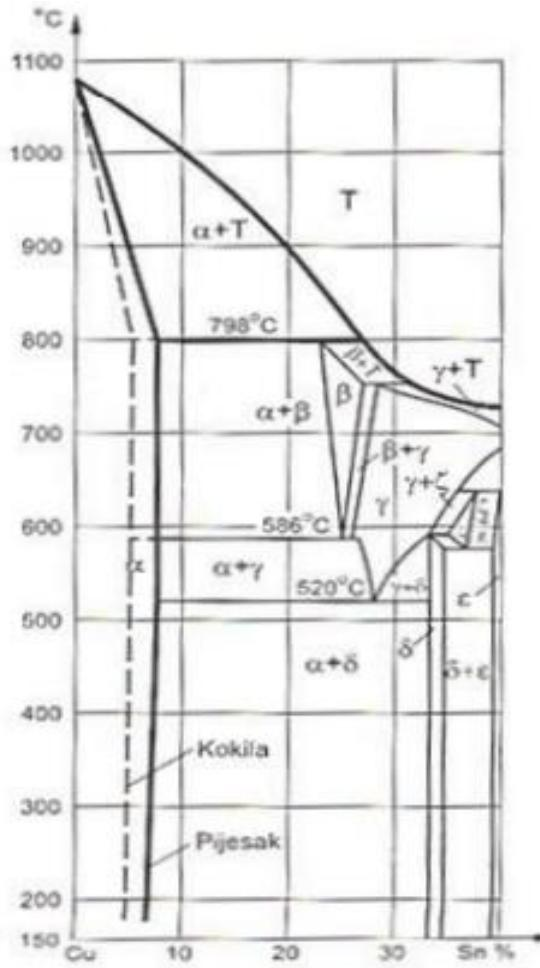
Slika 2.4 Dijagramski prikaz lijevanog stanja Cu – Sn [1].
