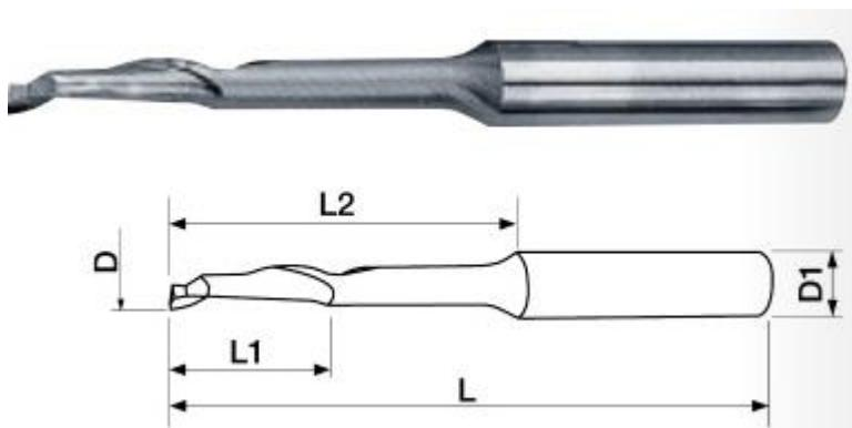
Slika 3.7 Dugačka izvedba glodala za urezivanje s drškom [6]
