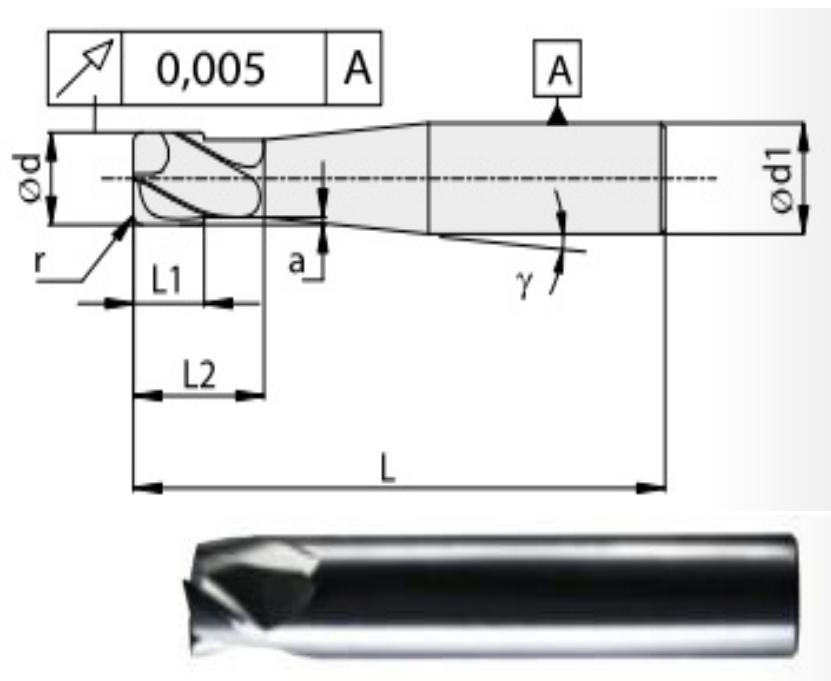
Slika 3.10 Trohoidalno glodalo za brtvene površine [6]
