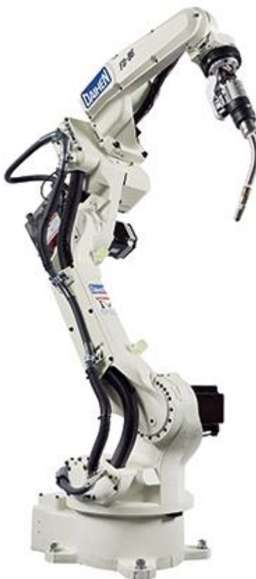
Slika 4.3. OTC Daihen FD-B6 robot [14]
