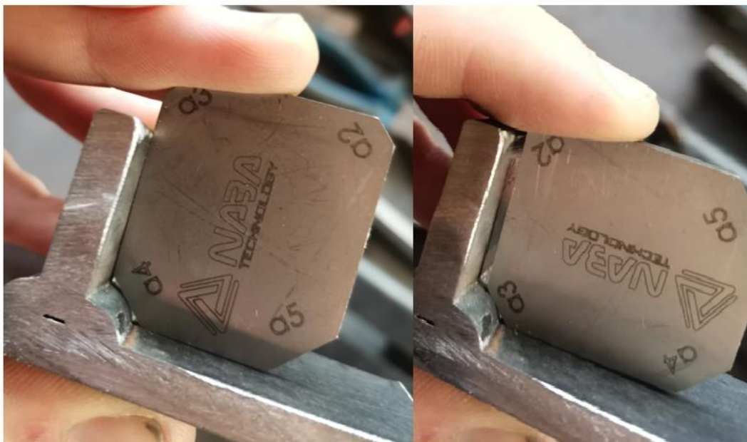
Slika 4.23. Mjerenje šablonom a3 i a4
