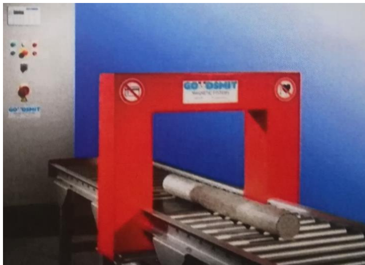
Slika 2.16. Uređaj za demagnetizaciju [17]
