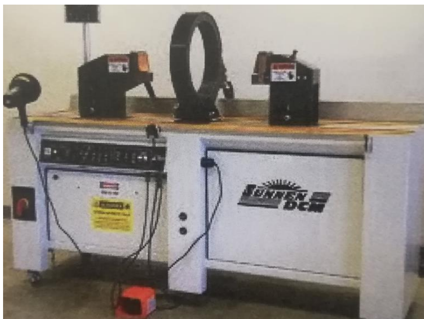
Slika 2.14. Stacionarni stoj za magnetiziranje [17]
