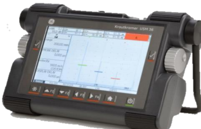
Slika 2.23. Ultrazvučni uređaj Krautkramer USM 36 [22]
