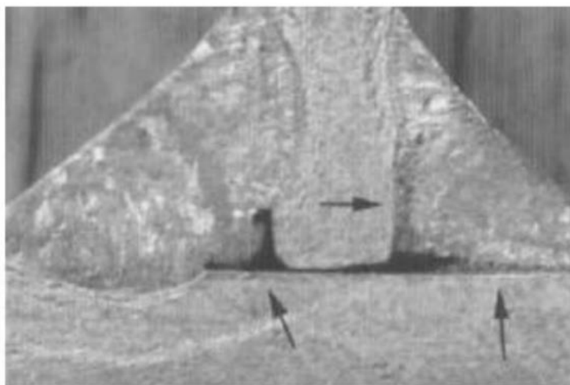
Slika 3.10. Naljepljivanje u kutnom spoju [29]
