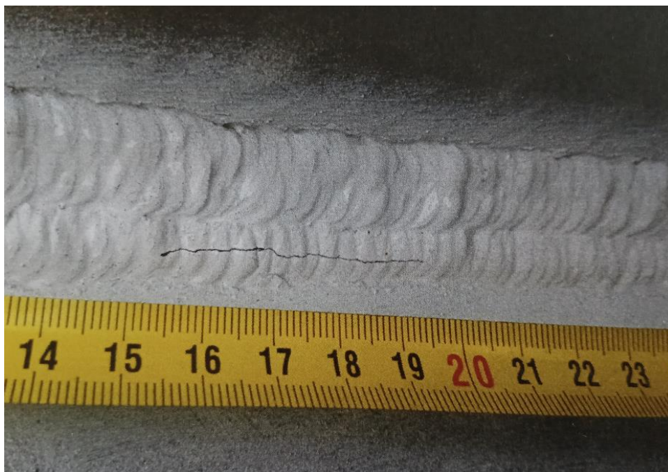
Slika 2.12. Magnetska indikacija otkrivena crno-bijelom tehnikom [17]
