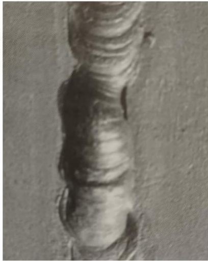
Slika 3.12. Pogreške oblika zavora – ugorine i ispupčenost kutnog zavora [29]
