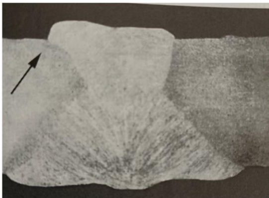
Slika 3.13. Pogreške oblika zavora – oštar prijelaz i preklop [29]
