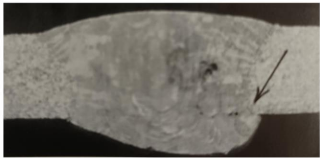
Slika 3.13. Pogreške oblika zavora – oštar prijelaz i preklop [29]
