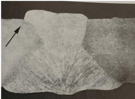
Slika 3.13. Pogreške oblika zavora – oštar prijelaz i preklop [29]
