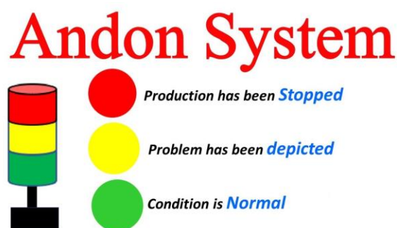
Slika 2. 16 Signalizacija u Andon metodi [11]
