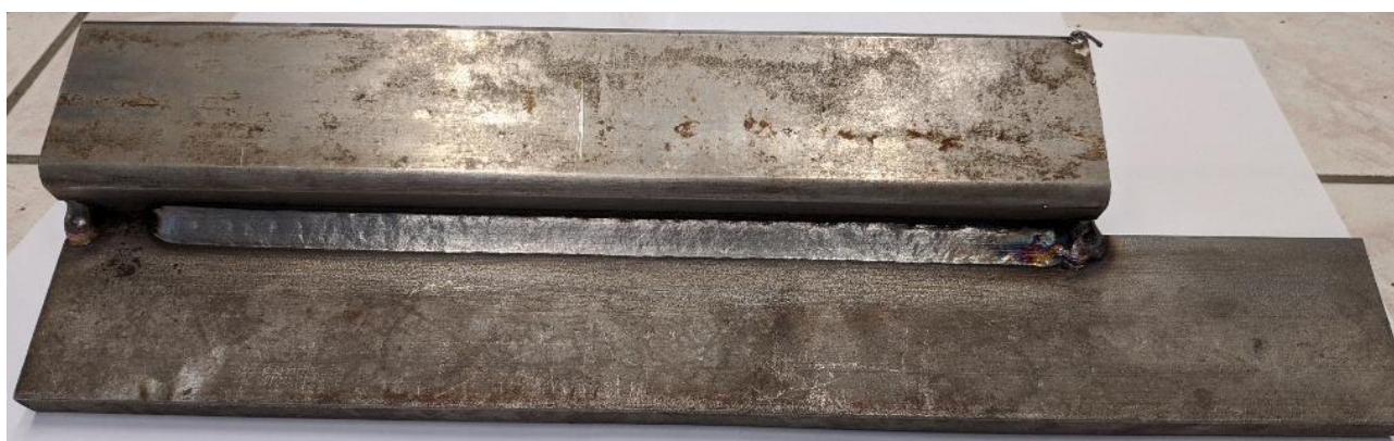
Slika 6.11 Očišćen prvi zavar
