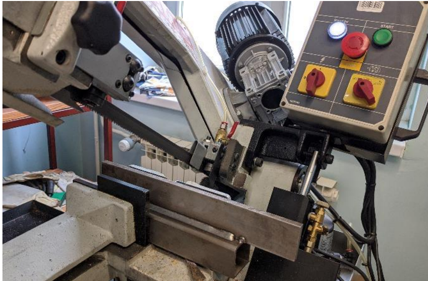
Slika 6.13 Rezanje obratka tračnom pilom
