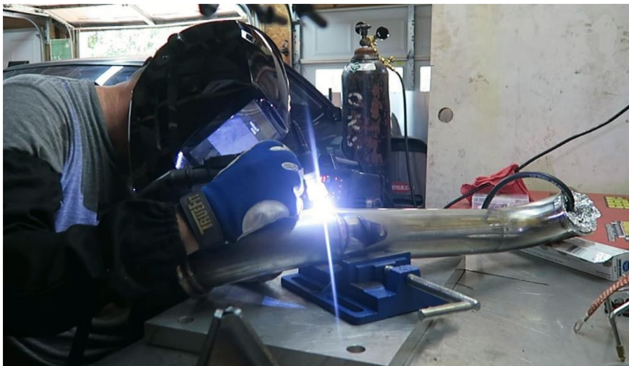
Slika 3.13 Primjer TIG zavarivanja ispušne cijevi od nehrđajućeg čelika [15]
