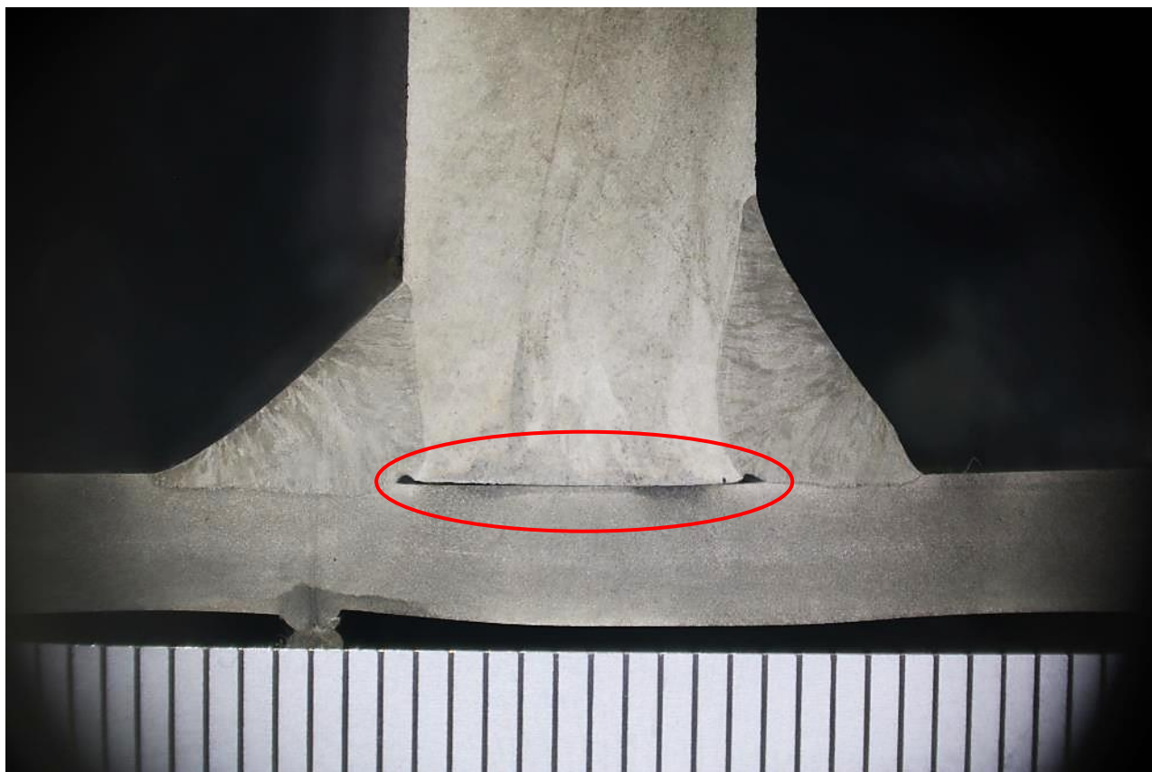
Slika 6.16 Makro prikaz spoja ispitnog uzorka
