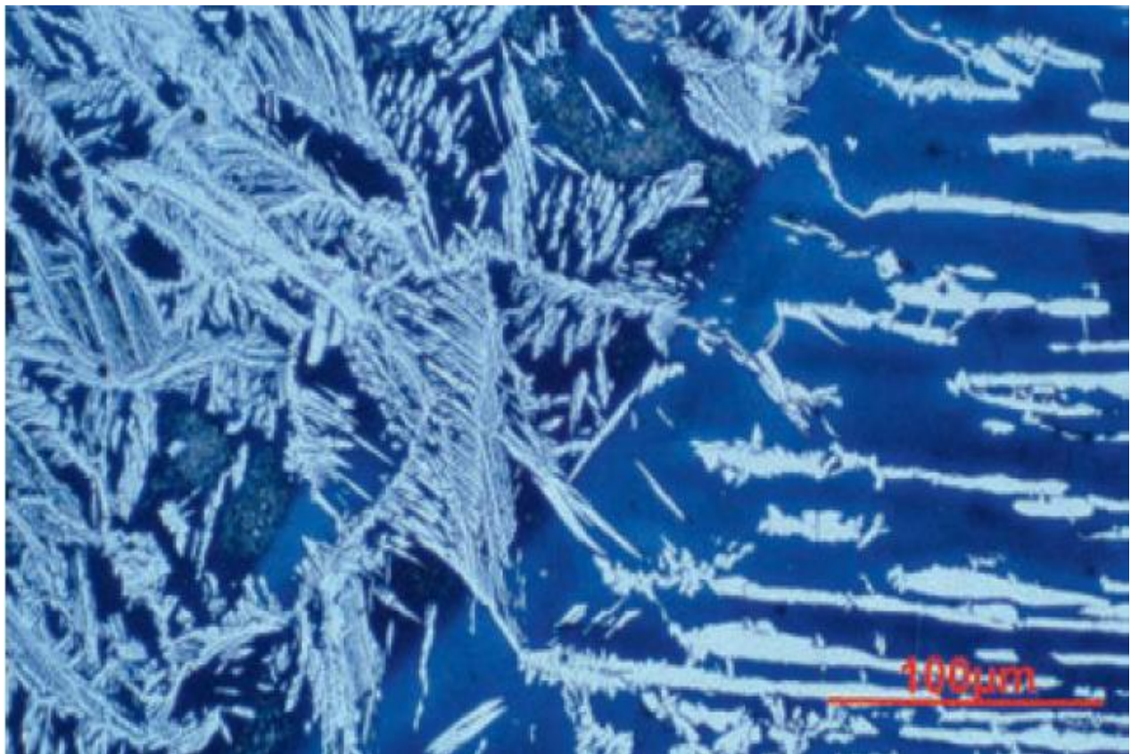
Slika 3.9 Mikrostruktura zavara dupleks čelika, osnovni metal desno, ZUT lijevo [12]
