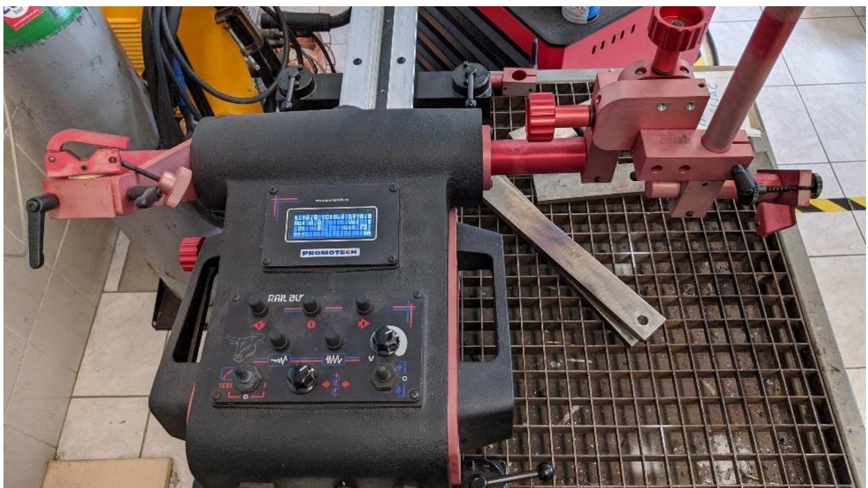
Slika 6.4 Rail Bull automat za pravocrtno zavarivanje
