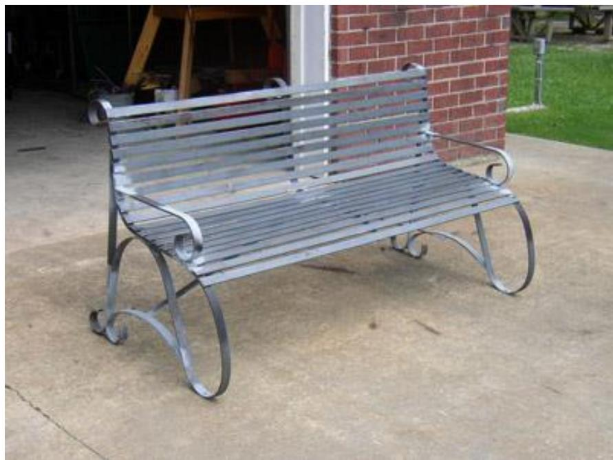
Slika 3.11 Klupa od nehrđajućeg čelika zavarena MIG postupkom [13]
