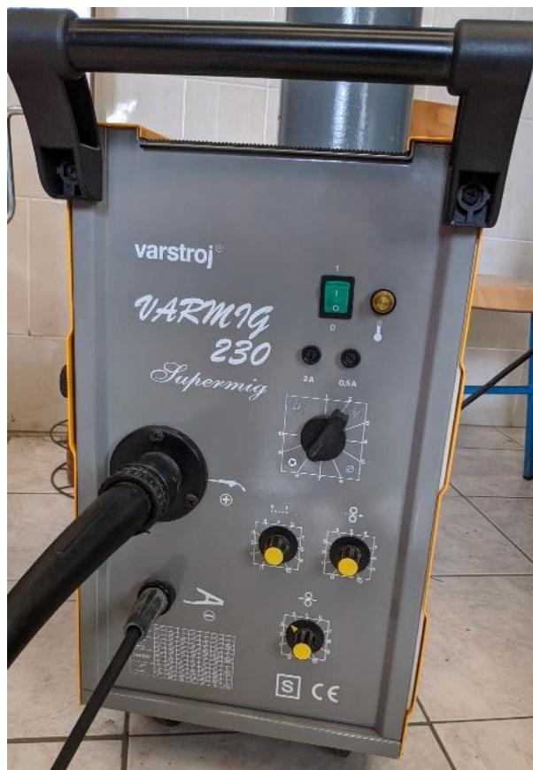
Slika 6.3 Varmig 230 Supermig izvor struje za zavarivanje
