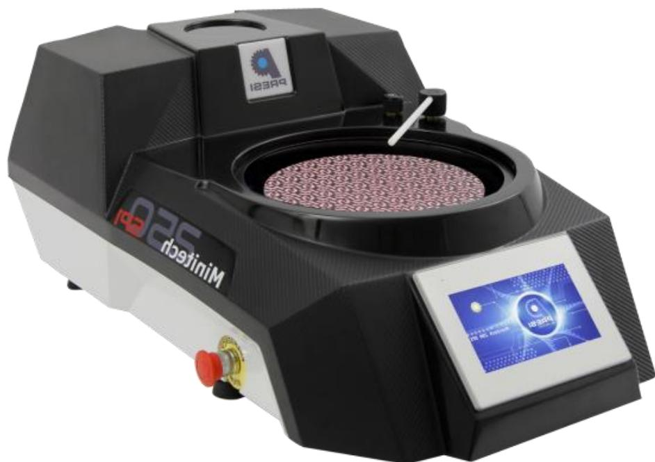
Slika 6.6 Stroj za poliranje MINITECH 250 SP1
