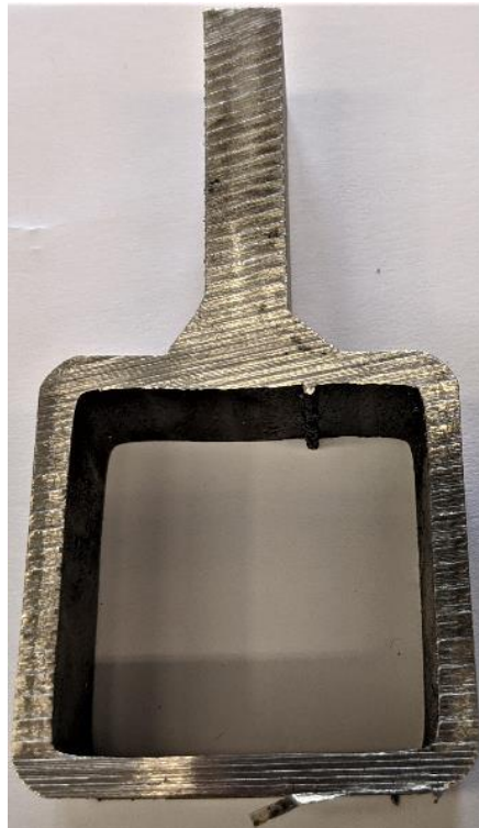
Slika 6.14 Izrezani ispitni uzorak
