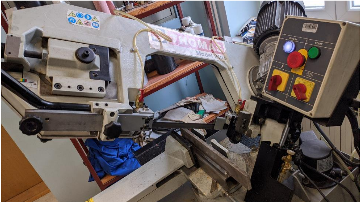
Slika 6.5 Tračna pila THOMAS 210S
