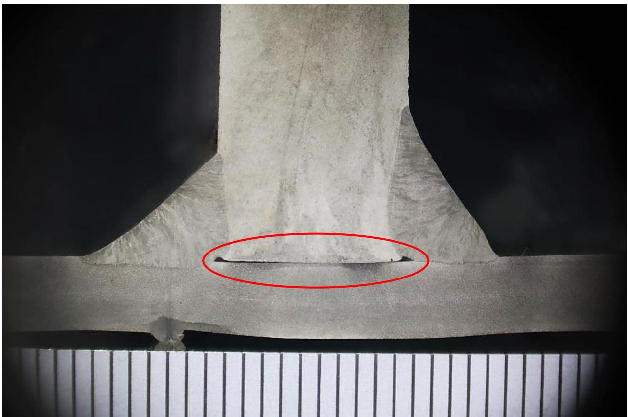
Slika 6.16 Makro prikaz spoja ispitnog uzorka
