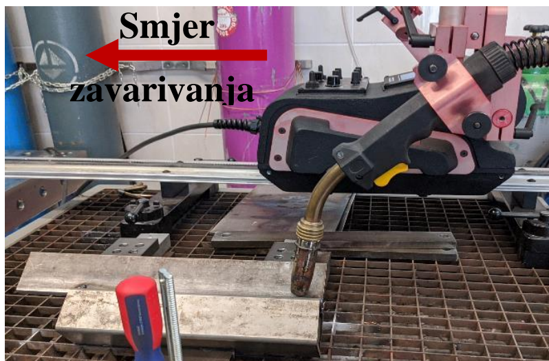
Slika 6.8 Namještanje automata za zavarivanje u PA položaju
