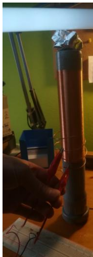
Slika 3.12. Probni rad pobuđivača napona na eksperimentalnoj pločici
