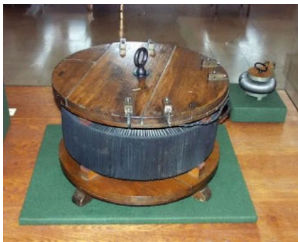
Slika 2.2. Prvi konstruirani transformator
