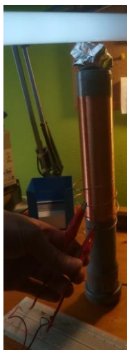
Slika 3.12. Probni rad pobuđivača napona na eksperimentalnoj pločici
