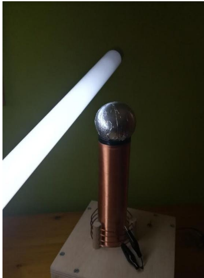
Slika 3.14. Širenje energije Teslinog transformatora
