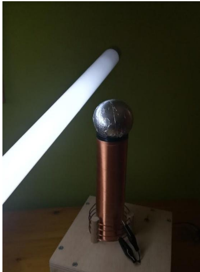
Slika 3.14. Širenje energije Teslinog transformatora
