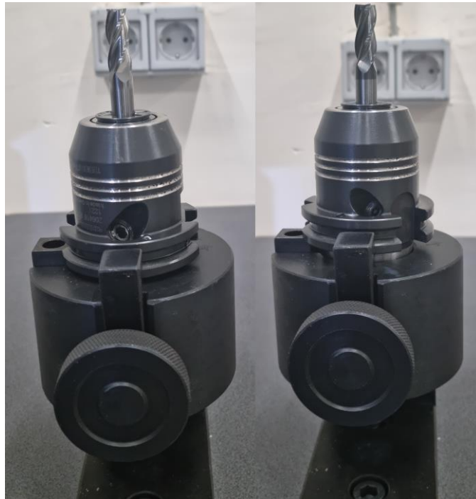
Slika 5. 6 Polirano glodalo (lijevo) i glodalo s prevlakom od Boroxa (desno)
