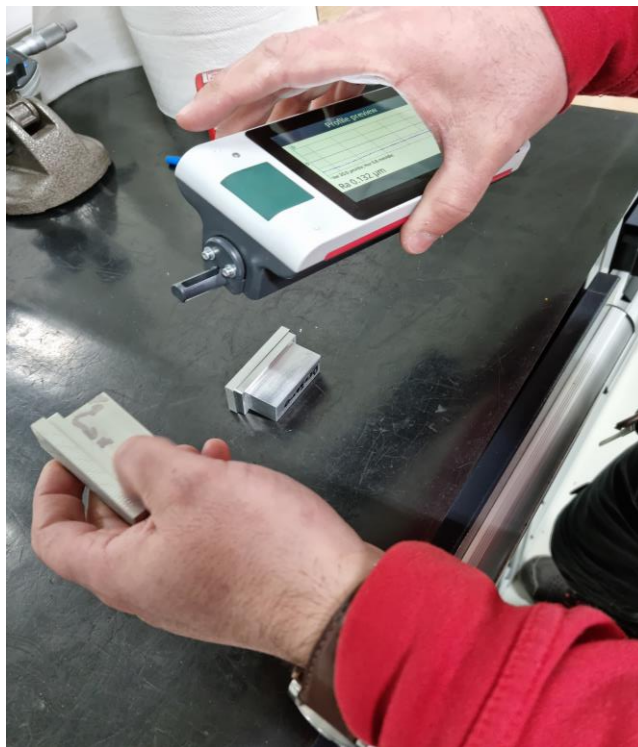
Slika 5. 11 Mjerenje hrapavosti površine
