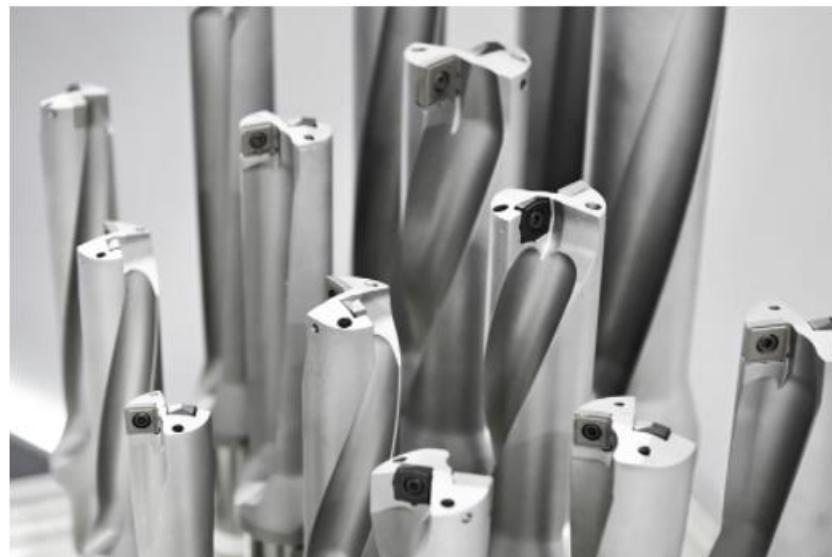
Slika 2. 5 Svrdla s pločicama od tvrdog metala [8]
