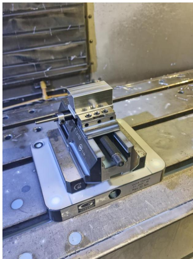
Slika 5. 7 Obradak u steznoj napravi
