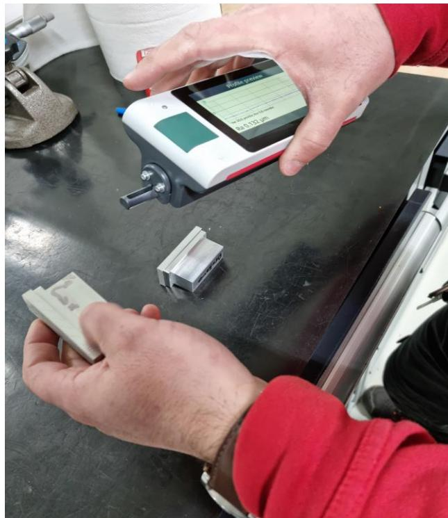
Slika 5. 11 Mjerenje hrapavosti površine
