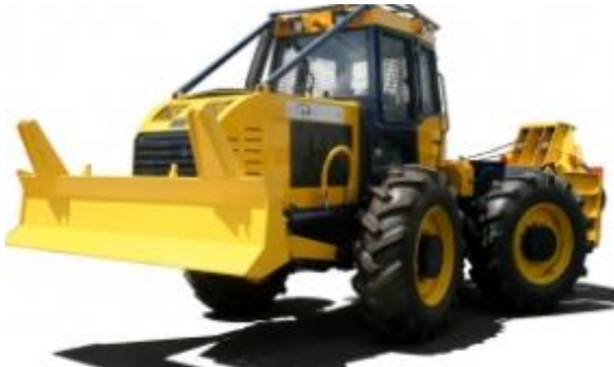
Slika 1 Šumski zglobni traktor EcoTrac 140 V [2]
