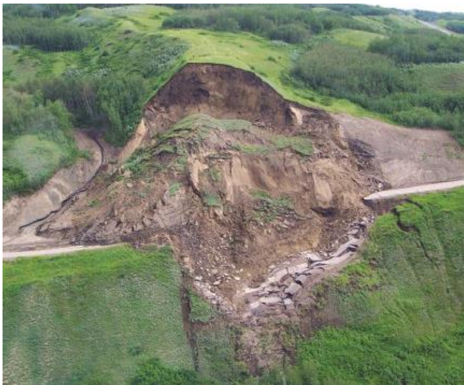
Slika 2.7.: Translacijsko klizanje aktivirano 2001. u Beatton River Valley, British Columbia, Canada [4]
