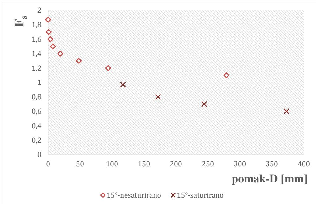
Slika 7.8. Usporedba pomaka nesaturiranog i saturiranog tla
