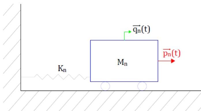
Slika 3.12.: Shematski prikaz sustava s više stupnjeva slobode
