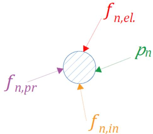
Slika 3.10.: Shematski prikaz djelovanja sila na točkastu masu
