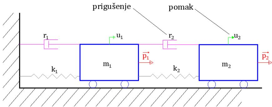
Slika 3.11.: Shematski prikaz sustava s dva stupnjeva slobode
