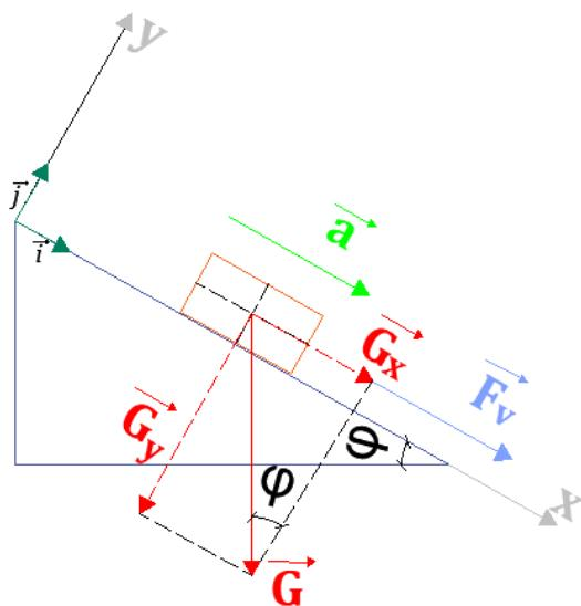
Slika 3.3.: Vektor ubrzanja u smjeru inicirane sile
