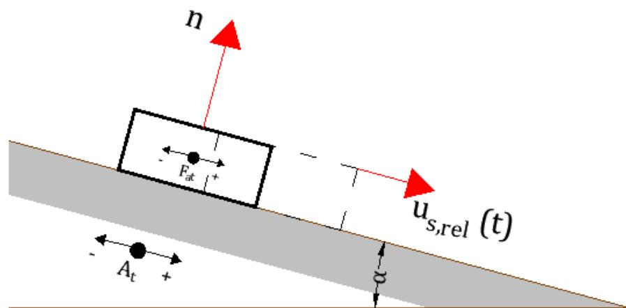
Slika 5.1.: Pojednostavljeni prikaz Newmarkovog kliznog bloka
