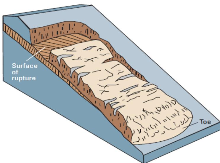
Slika 2.3.: Shematski prikaz translacijskog klizanja [4]
