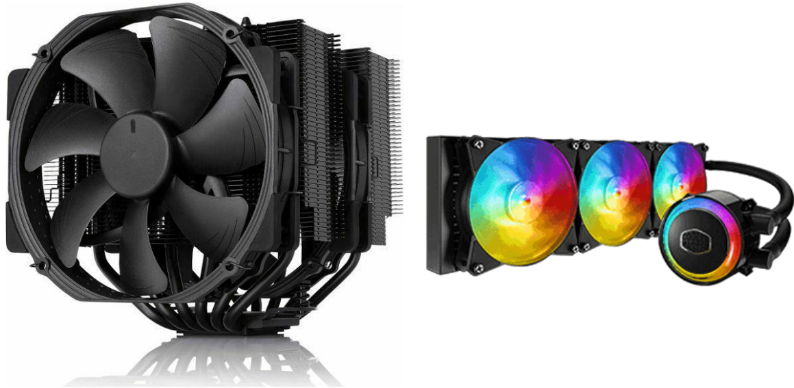
Slika 4.13 Prikaz zračnog hladnjaka i vodenog [46], [47]
