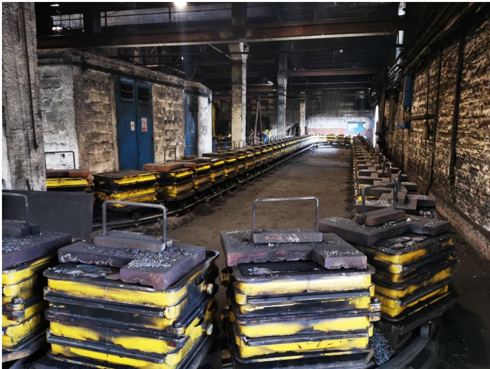
Slika 3.3 Linija hlađenja odljevaka prije istresanja [8]
