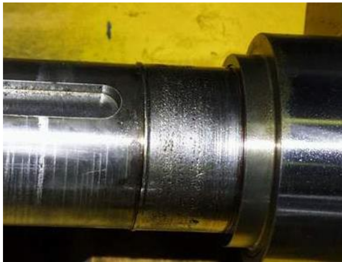
Slika 2.5 Oštećenje ležajnog mjesta uzrokovano trošenjem [8]
