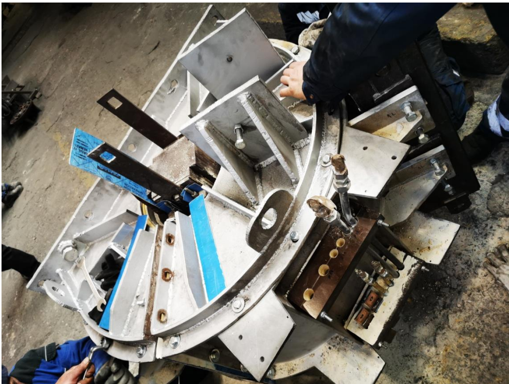
Slika 4.1 Induktor odvojen od posuda[8]
