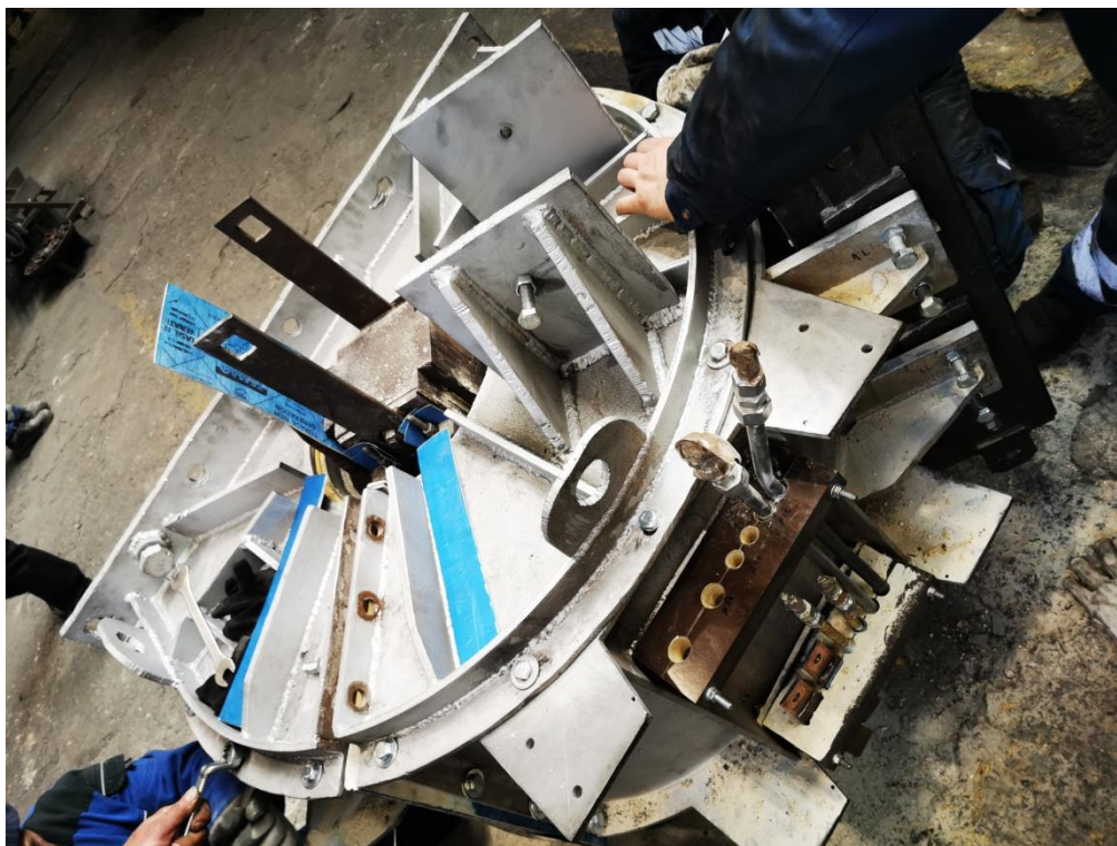
Slika 4.1 Induktor odvojen od posuda[8]
