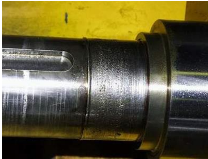
Slika 2.5 Oštećenje ležajnog mjesta uzrokovano trošenjem [8]
