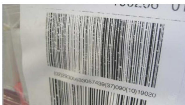
Slika 4-11 Primjer loše otisnutog kôda simbologije GS1-128 na logističkoj naljepnici
