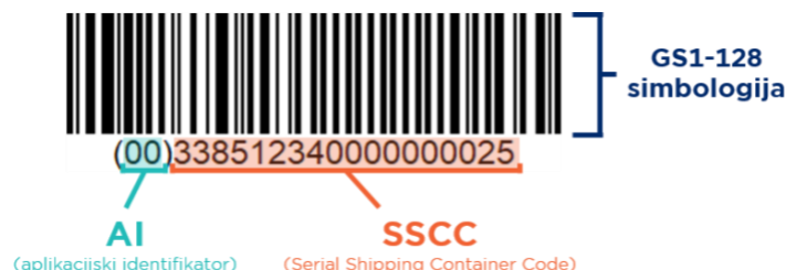
Slika 3-5 Primjer SSCC kôda
