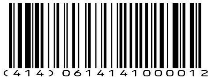
Slika 3-4 GS1-128 simbologija u kojoj je kodiran GLN upotrebom AI (414) prefiksa (Identifikacija fizičke lokacije)
