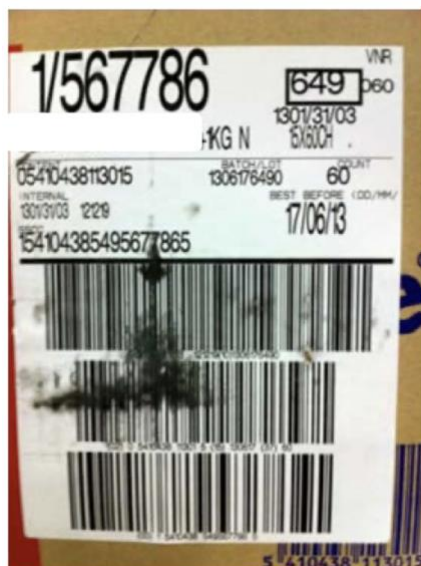
Slika 4-12 Primjer odabire neadekvatnog medija ili tinte za ispis logističke naljepnice
