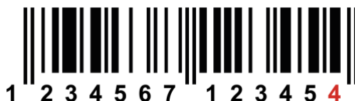
Slika 3-3 Primjer EAN-13 simbologije s pogrešnom kontrolnom znamenkom
