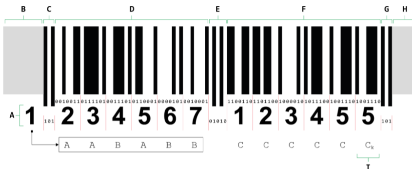
Slika 3-2 Prikaz elemenata EAN-13 crtičnog kôda
