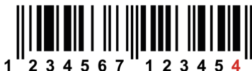
Slika 3-3 Primjer EAN-13 simbologije s pogrešnom kontrolnom znamenkom
