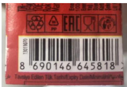
Slika 4-2 Prikaz neadekvatne simbologije te nedovoljne visine i prostora svijetlih margina
