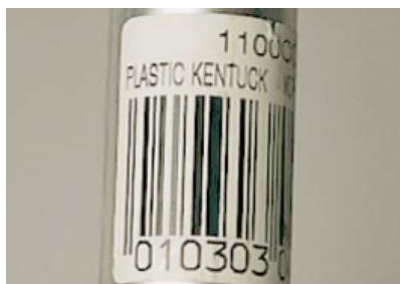
Slika 4-8 Prikaz pogrešno apliciranog barkoda na zaobljenoj površini
