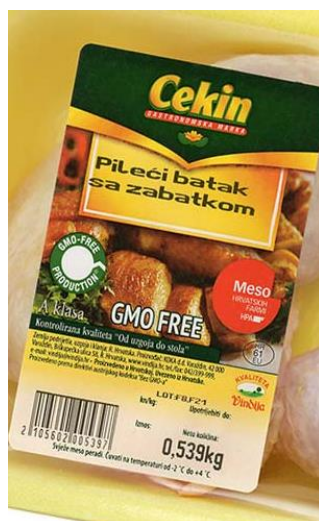
Slika 3-7 Primjer etikete s CRO-SCAN kôdom s prefiksom 21 (roba promjenjive težine)
